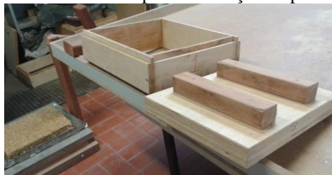
Figura 23- Forma vazada para a formação do painel.
