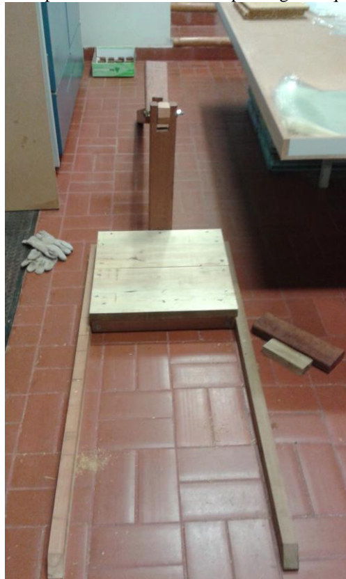
Figura 25- Pré - prensa utilizada antes da prensagem a quente.
