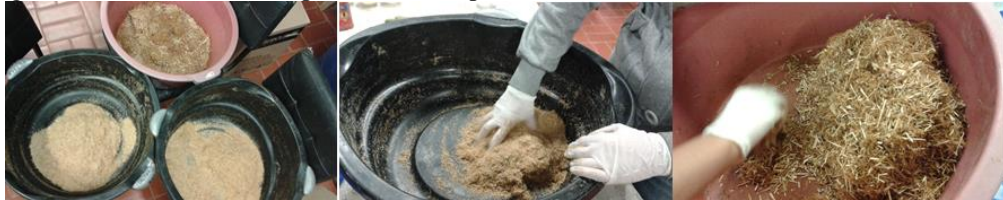
Figura 21-As três camadas separadas em recipientes e a mistura do adesivo manualmente.
