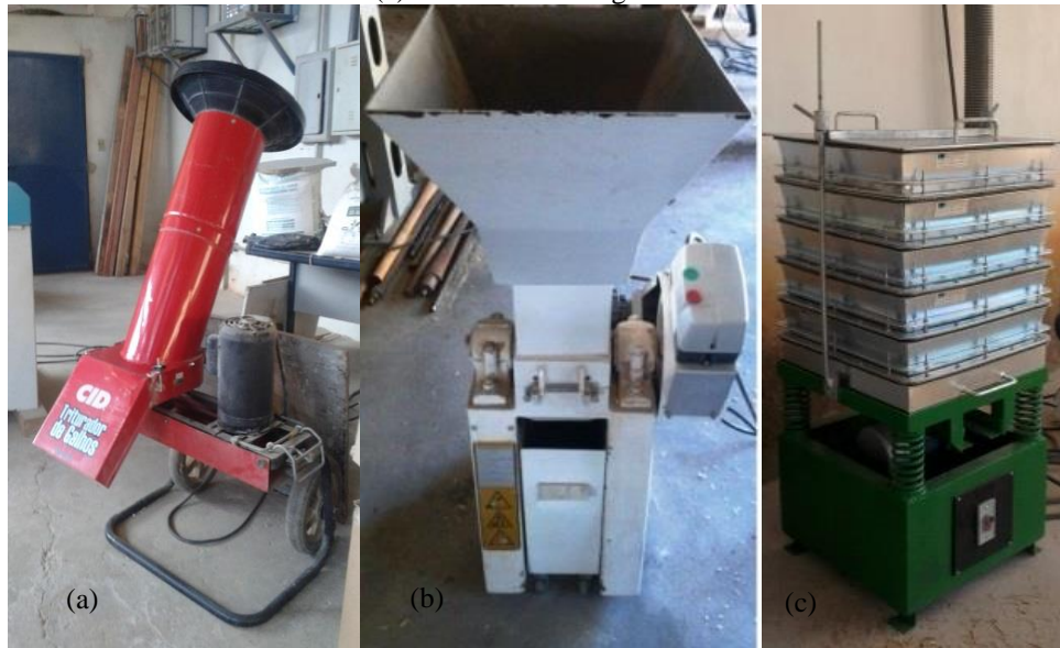
Figura 18-Equipamentos utilizados para a geração das partículas; (a) Triturador de galhos, (b) Picador de facas e (c) Peneira eletromagnética.
