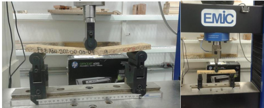
Figura 34- Ensaio de determinação da resistência à flexão estática e módulo de elasticidade.
