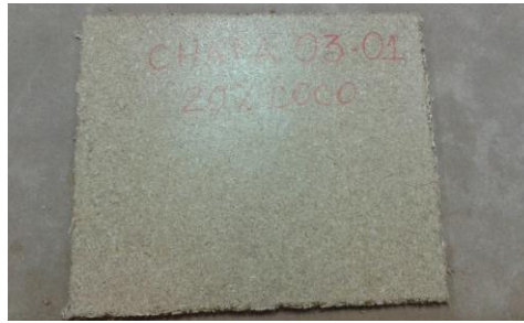
Figura 28- Chapa de MDP composta de bambu e fibra de coco, tratamento 80-20.
