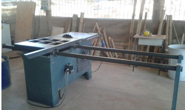
Figura 30- Serra circular utilizada para os cortes dos corpos de prova.
