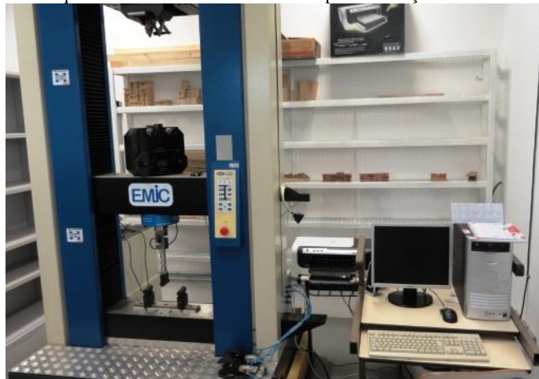
Figura 33- Máquina universal de ensaios utilizada para realização dos testes mecânicos.
