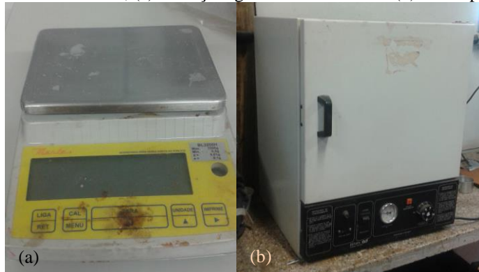
Figura 31-Equipamentos utilizados; (a) balança digital semi-analítica e (b) estufa para secagem.
