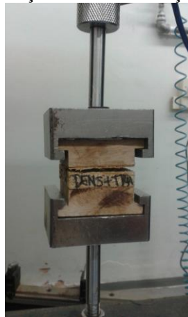
Figura 35- Realização do ensaio de tração perpendicular.
