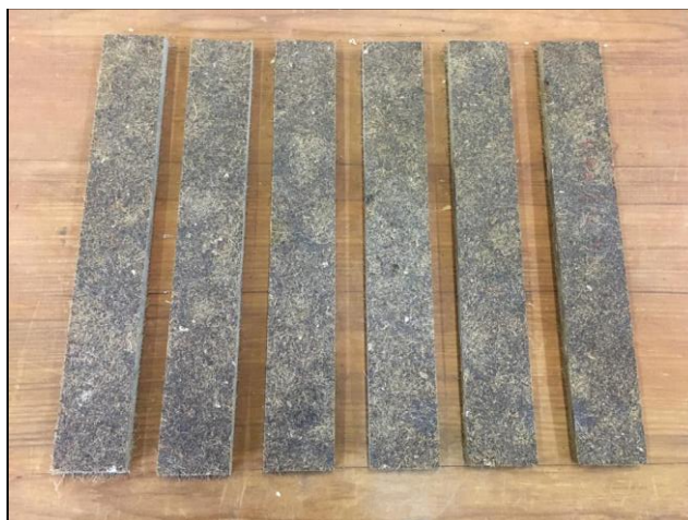
Figura 51 – Corpos de prova utilizados para realização dos ensaios de MOR e MOE da composição F100 P0 E0.
