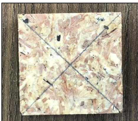
Figura 47 - Corpo de prova utilizado para realização do ensaio de densidade.
