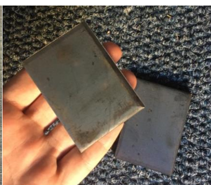
Figura 55 – Preparação do conjunto CP's e suportes metálicos para realização do ensaio de Tração Perpendicular.
