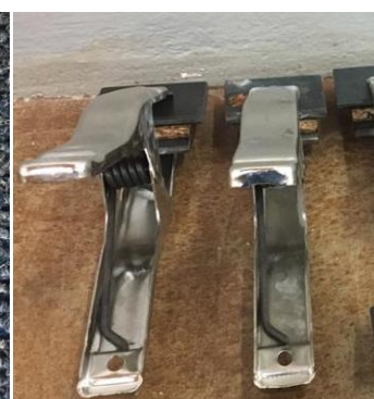
Figura 55 – Preparação do conjunto CP's e suportes metálicos para realização do ensaio de Tração Perpendicular.
