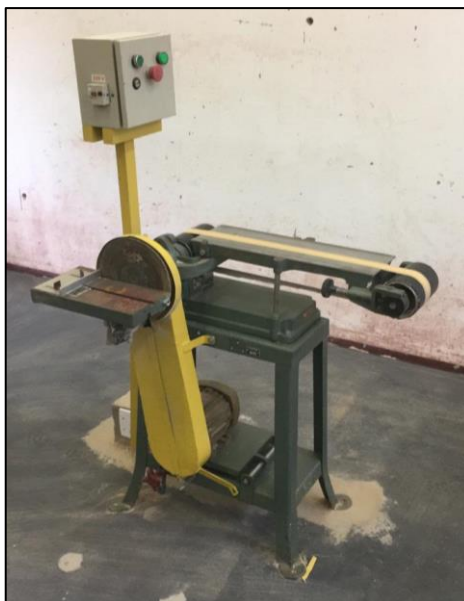
Figura 54 - Lixadeira empregada na regularização das superfícies dos CP's.
