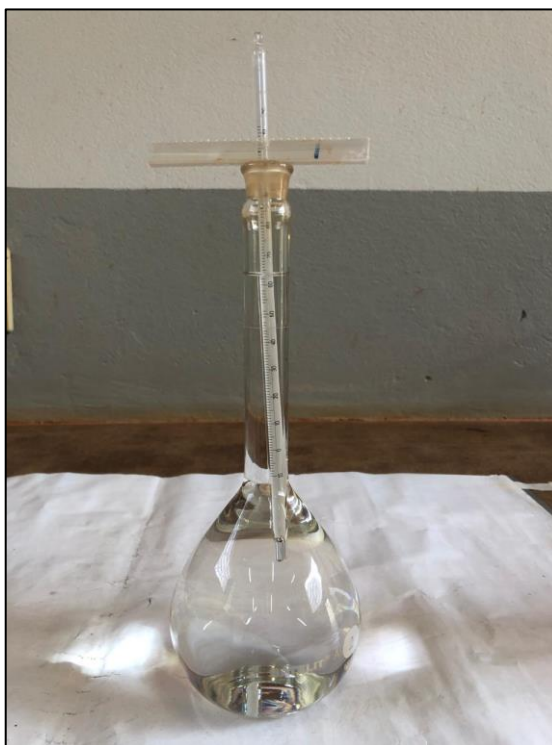
Figura 33 – Picnômetro, termômetro e álcool absoluto utilizados para determinação da massa específica das partículas.
