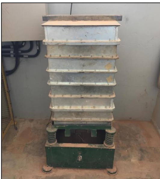
Figura 31 - Conjunto de peneiras e agitador utilizado para separação prévia das partículas.
