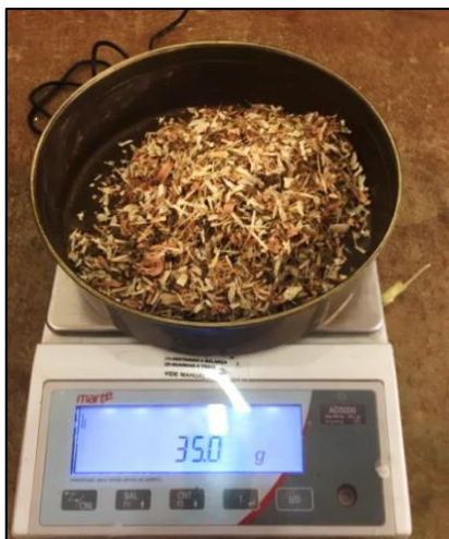
Figura 39 - Procedimento: obtenção das 35 gramas de partículas.
