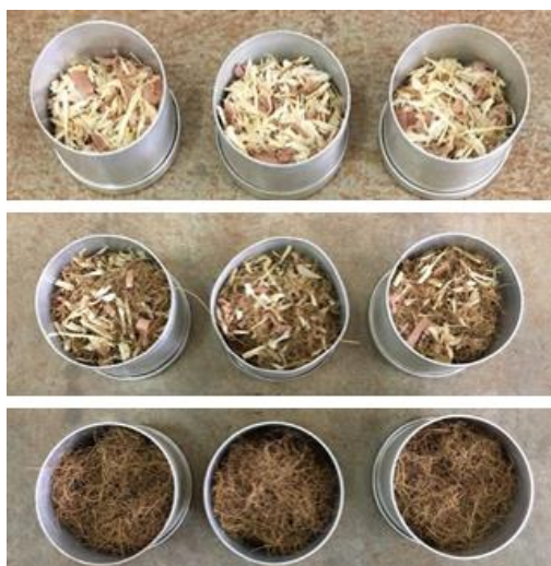
Figura 40 - Amostras utilizadas para determinação do teor de umidade das composições propostas na Tabela 5.
