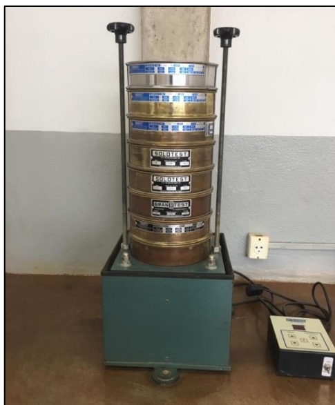
Figura 37 - Conjunto e agitador de peneiras, utilizados no ensaio granulométrico.
