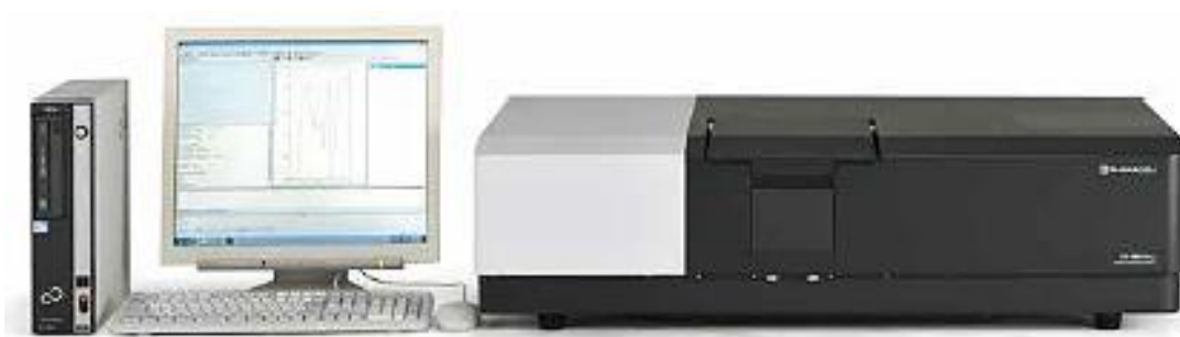
Figura 41: Espectrofotômetro de UV-Vis utilizado para obter o bandgap das amostras.
