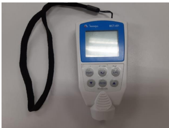
Figura 40: Equipamento de corrente parasita utilizado na leitura da espessura dos revestimentos. Propriedade de Thaís Matiello.
