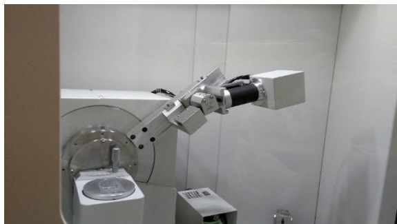
Figura 34: Difratormetro de Raios-X da UFSCAR, Sorocaba. A foto mostra o posicionamento da amostra por um suporte a vácuo.
