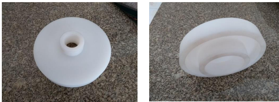
Figura 31: Tampa projetada para diminuir evaporação e escape de solução.
