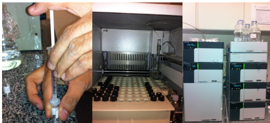
Figura 5- Amostra de saliva sendo filtrada e inseridas em cromatógrafo com fase móvel.
