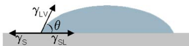
Figura 2.6 – Representação esquemática do ângulo de contato \theta medido entre o plano tangente à superfície do líquido e um plano tangente à superfície do sólido.
