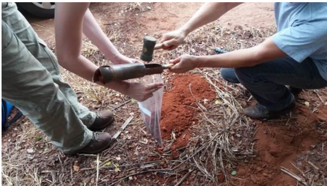
Figura 23. Coleta da amostra de amostra de profundidade de 100 cm no segundo ponto da fazenda (P2) usando um martelinho para desprender o solo do trado para dentro dos sacos plásticos.
