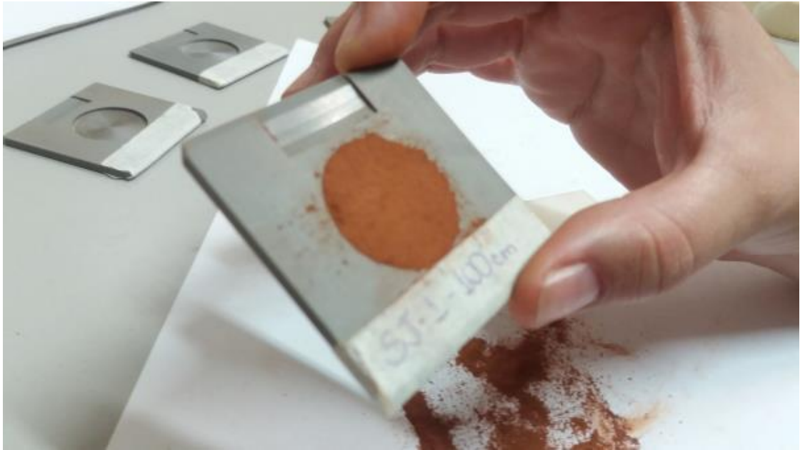
Figura 28. Disposição da amostra de solo na pastilha prensada.
