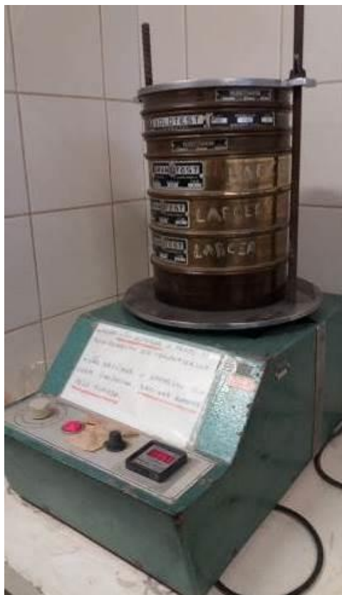
Figura 27. Peneiramento das amostras de solo usando um agitador de peneiras.
