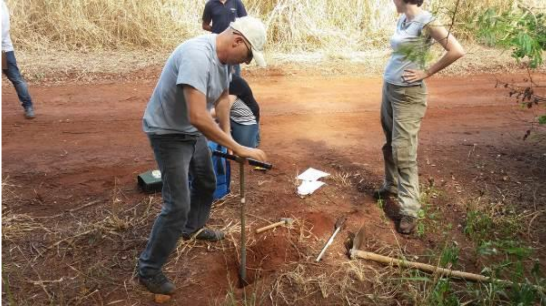
Figura 21. Coleta das amostras de solo de profundidades de 30 cm e 100 cm no primeiro ponto da Fazenda (P1) usando um trado.
