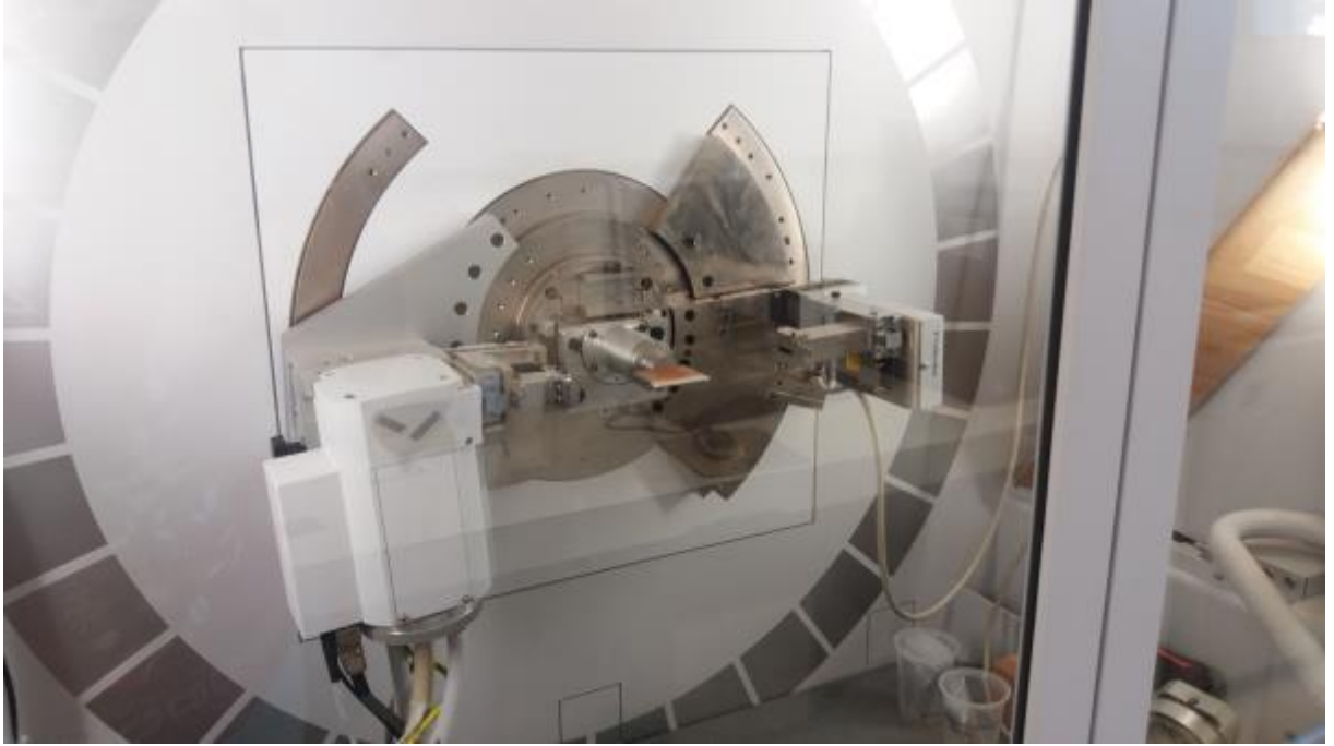
Figura 30. Inserção da pastilha com a amostra no difratômetro de Raios-X.
