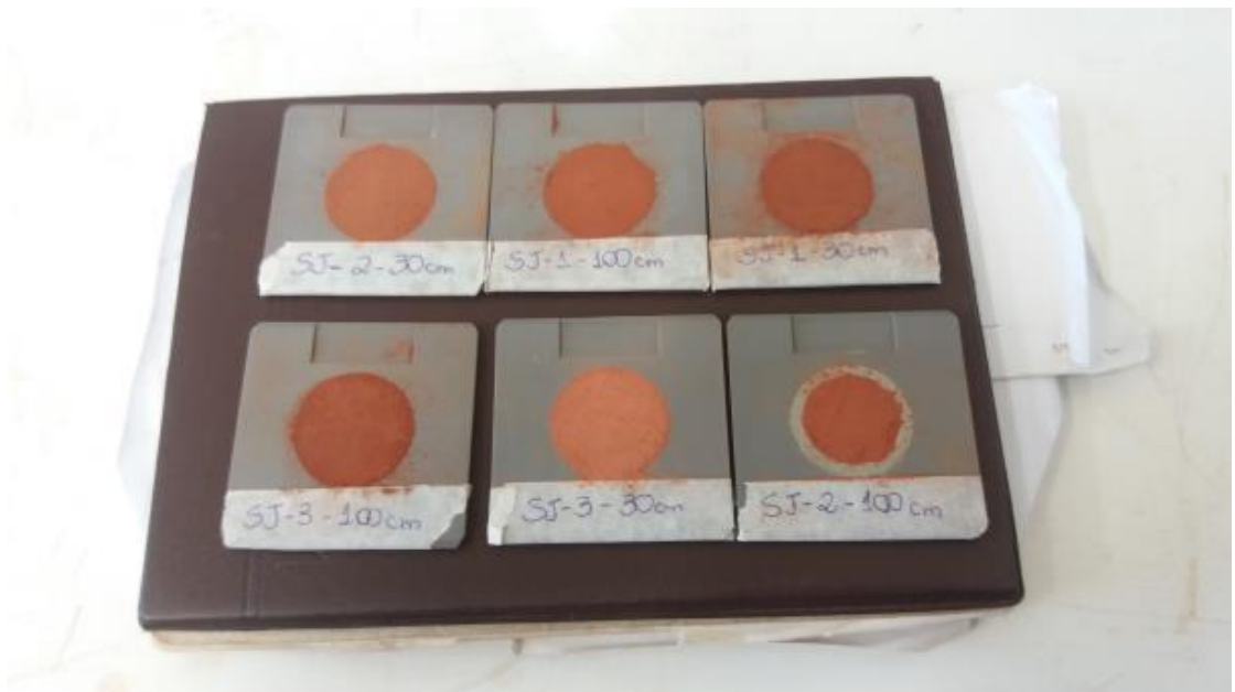
Figura 29. Pastilhas prensadas das seis amostras de solo da Fazenda da área de estudo.
