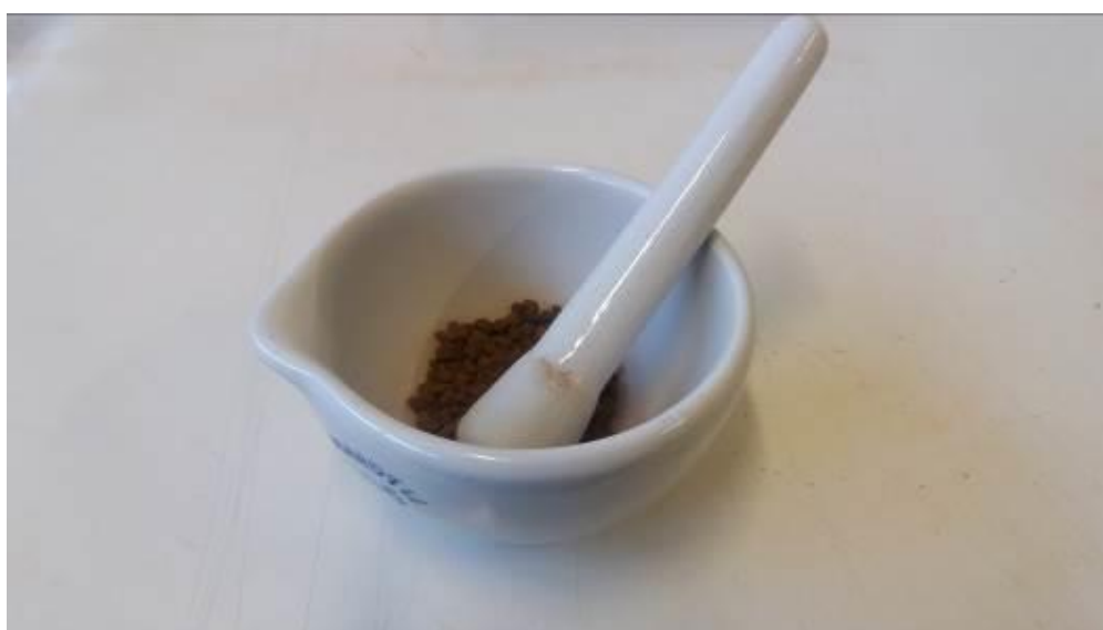
Figura 25. Desagregação de torrões de solo com o auxílio de um almofariz e um pistilo.
