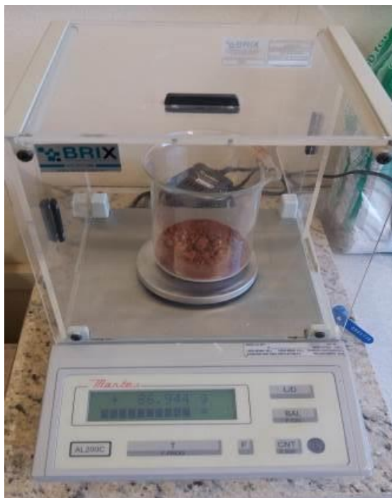
Figura 26. Pesagem de 100g de amostras de solo usando um Béquer em uma balança de precisão.
