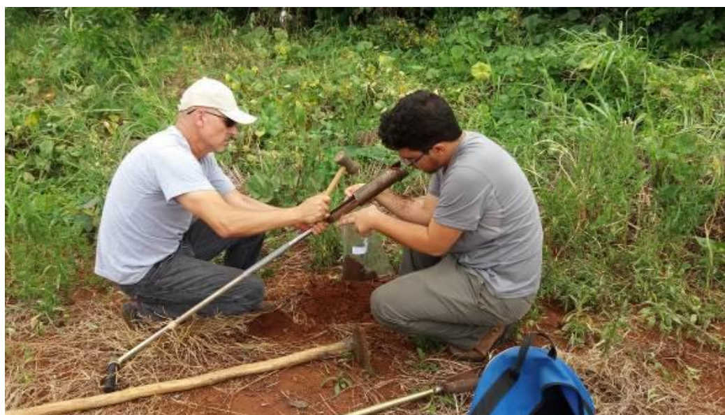
Figura 24. Amostragem de perfil de solo de profundidade de 30 cm no terceiro ponto da Fazenda (P3).
