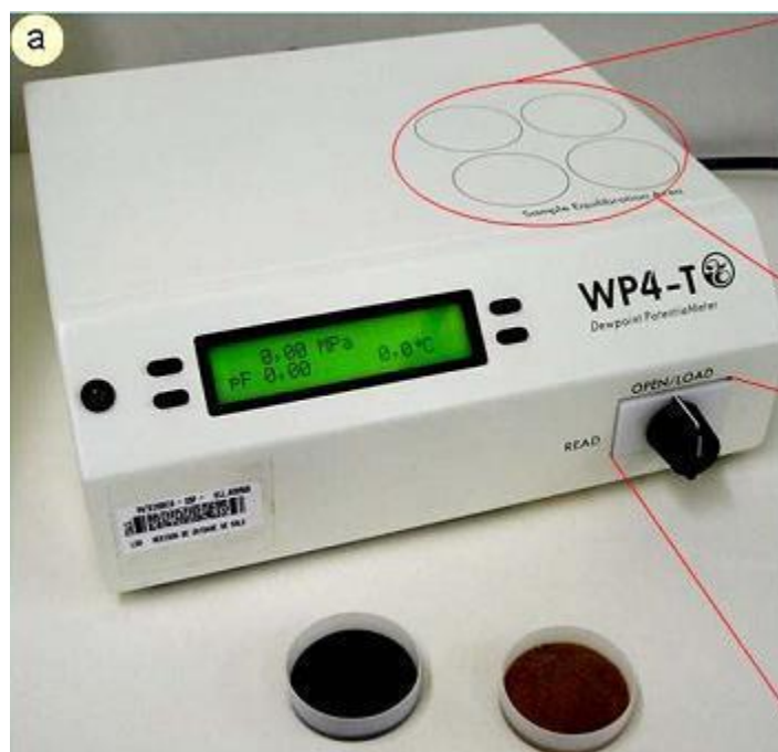
Figura 1. Medidor de potencial de água WP4-T.
