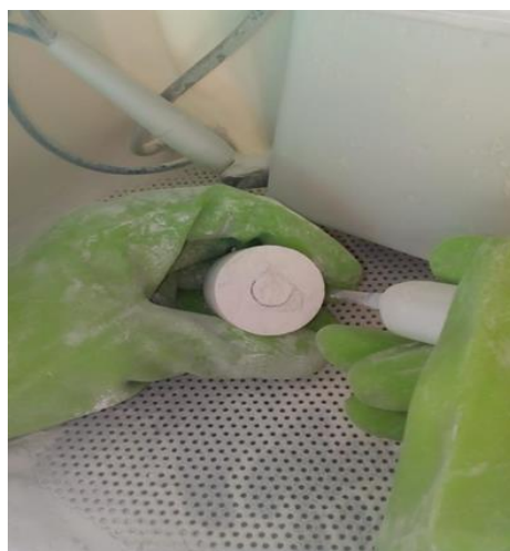
Figura 7 – Remoção das pastilhas do cilindro com auxílio de jateamento com óxido de alumínio
