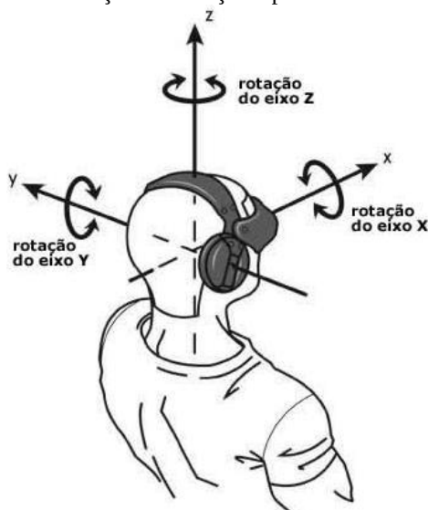
Figura 29 - Sistema cartesiano de coordenadas e ângulos de rotação, correspondentes a posição e orientação da cabeça respectivamente.
