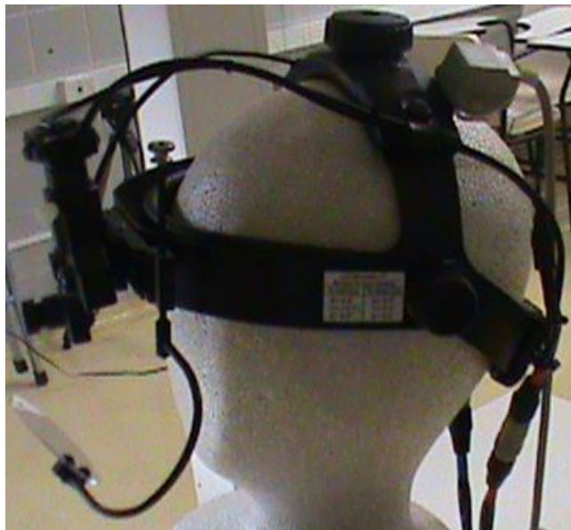
Figura 28 - Eye tracker e head tracker acoplados e com funcionamento integrado e sincronizado.
