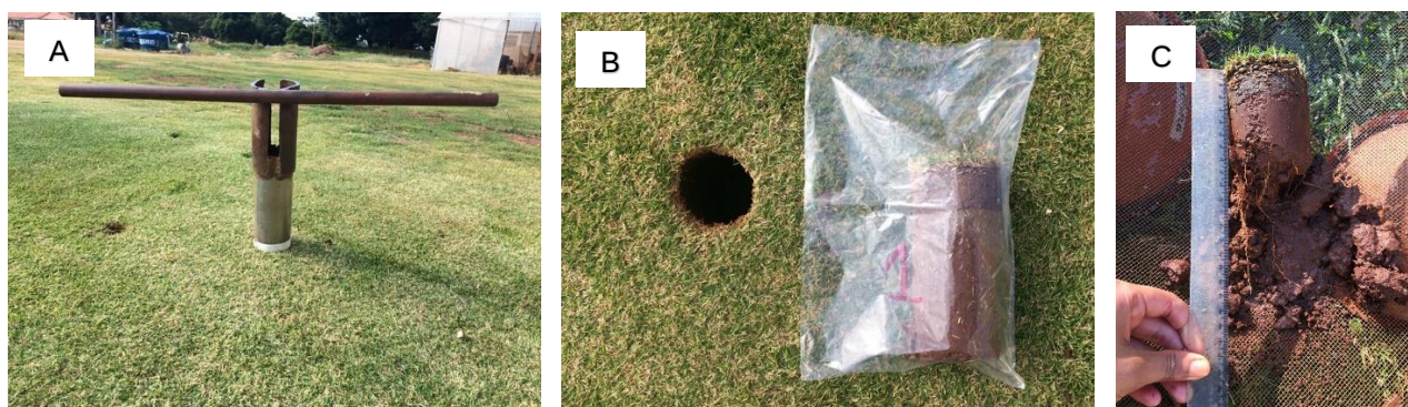
Figura 15 – Trado utilizado para quantificação (A), amostra retirada por meio do trado (B), medição da raiz (C) - Botucatu, SP, 2019
