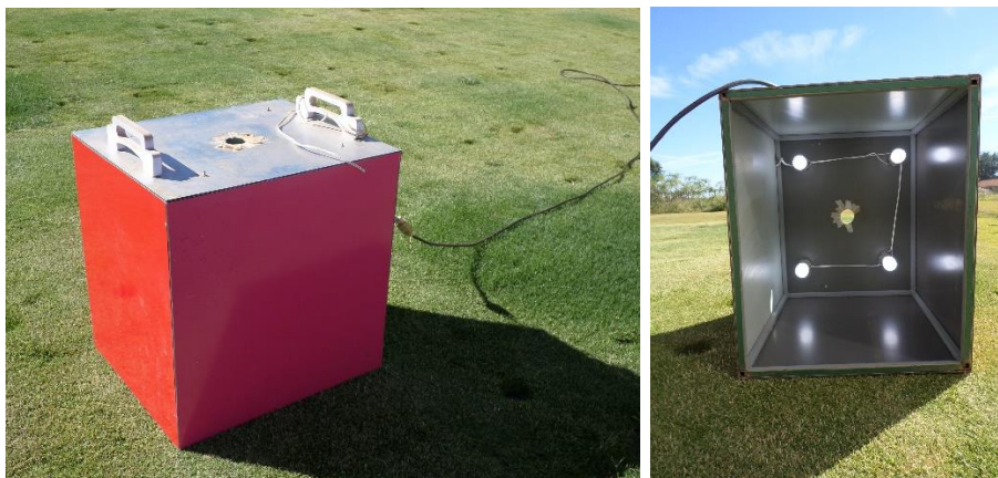
Figura 10 - Caixa light box utilizada para suporte da câmera digital - Botucatu, SP, 2019
