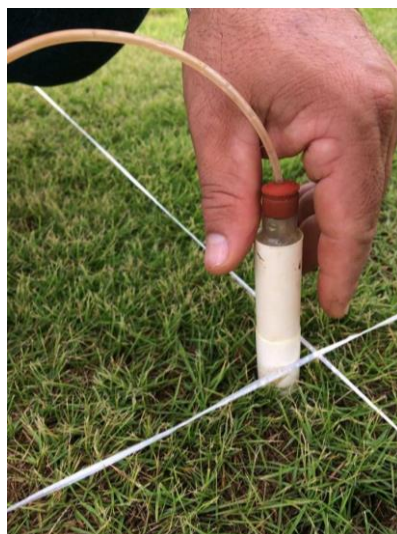
Figura 29- Extrator de solução do solo utilizado na área experimental - Botucatu, SP, 2019
