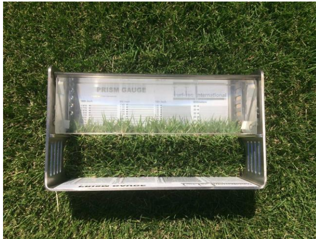
Figura 13 - Equipamento “Grass Height Prism Gauge” para determinação da altura do gramado - Botucatu, SP, 2019
