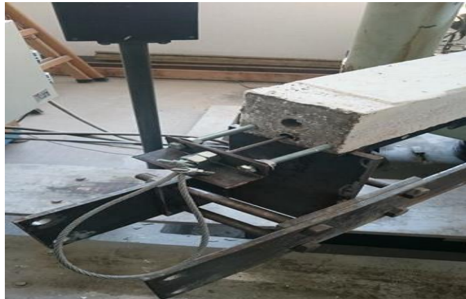
Figura 37 - Sistema para protensão do cabo de aço
