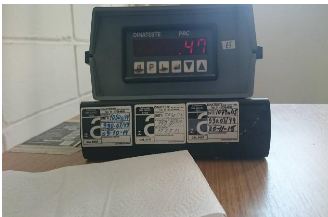
Figura 50 - A viga protendida rompeu à uma intensidade de esforço de 0,47 tf.
