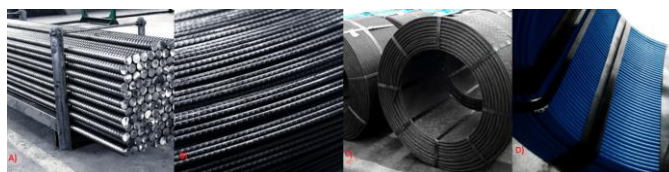
Figura 15 - a) tirantes de aço; b) fios de aço; c) cordoalhas nuas de aço; d) cordoalhas engraxadas e plastificadas.
