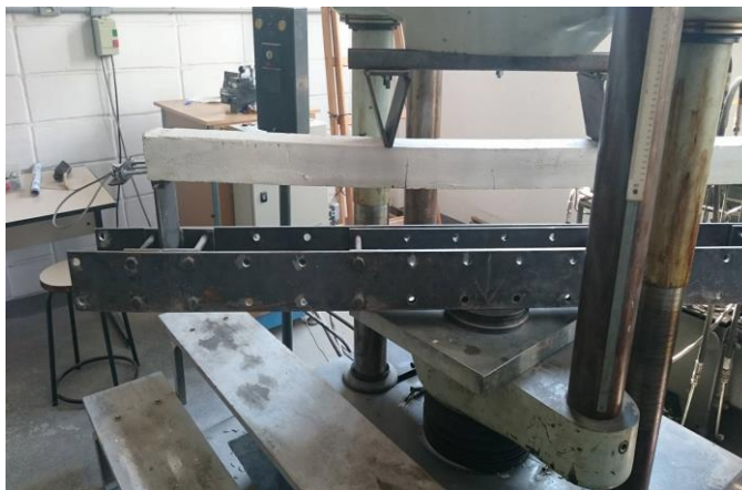
Figura 49 - Fissurações do lado frontal da viga à 0,26 tf.
