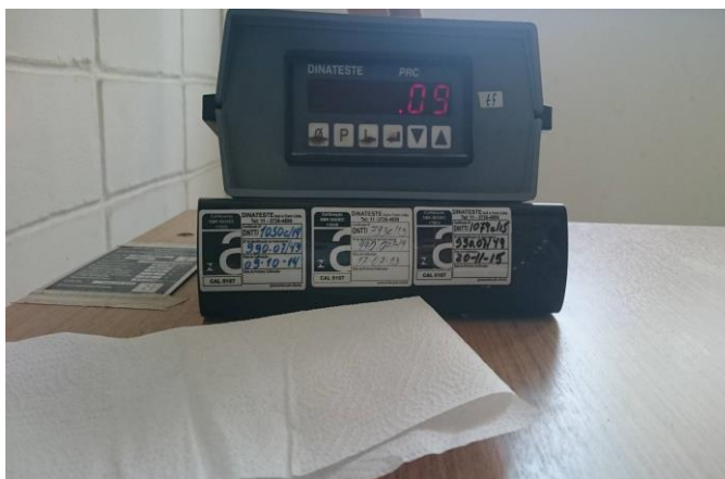
Figura 42 - Indicação da intensidade da força em toneladas da máquina universal de ensaios em que houve uma pausa do ensaio para fotos.
