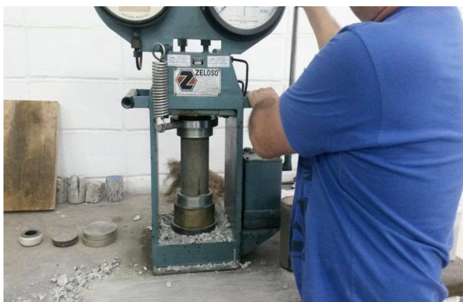
Figura 25 - Corpos de prova de graute sendo testados na máquina universal de ensaios
