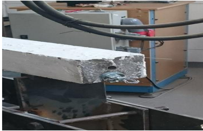
Figura 36 - Presilhas utilizadas para ancoragem numa das extremidades da viga
