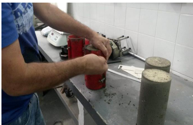
Figura 24 - Graute sendo colocado nas formas de corpo de prova
