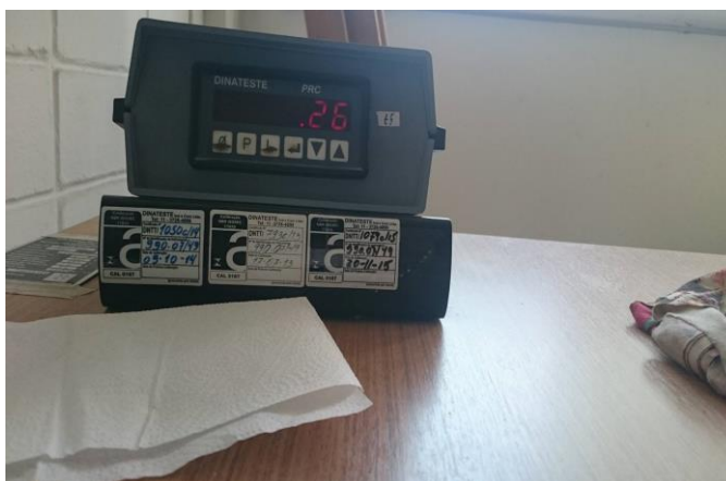
Figura 44 - Indicação da intensidade da força em toneladas da máquina universal de ensaios em que houve uma pausa do ensaio para fotos.
