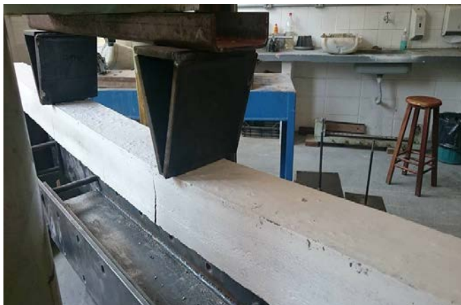
Figura 53 - Parte oposta da viga após rompimento.
