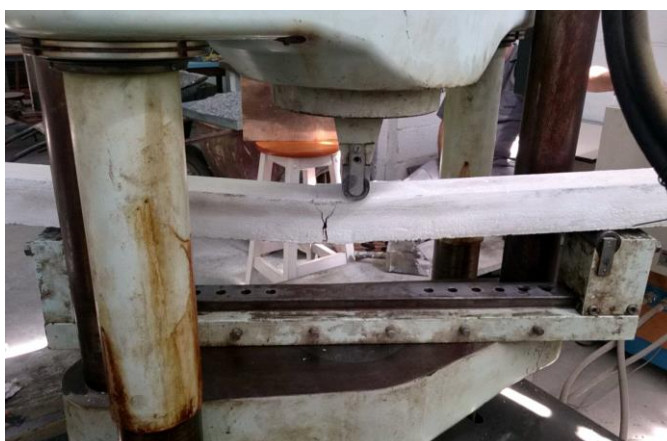
Figura 31 - Viga sendo testada na máquina universal de ensaios.
