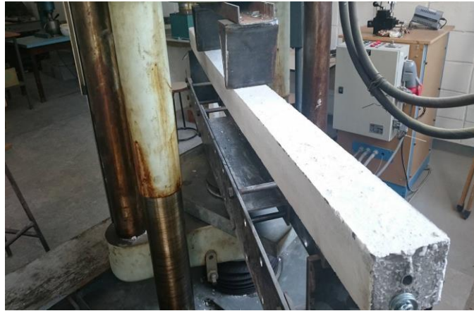
Figura 40 - Viga antes do ensaio na máquina universal de ensaios.
