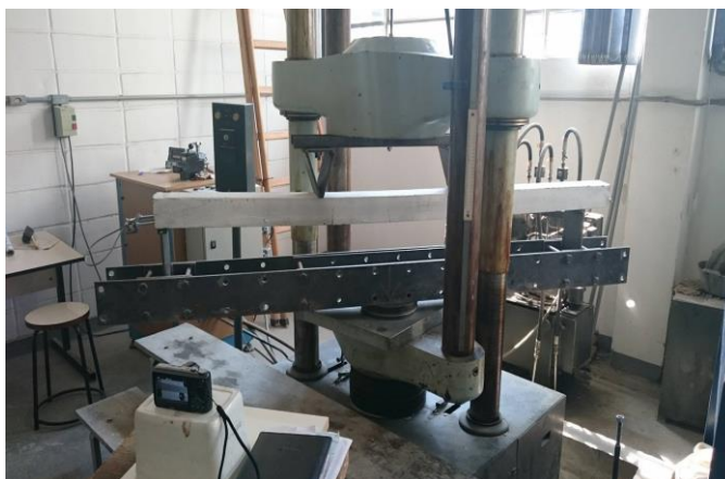
Figura 46 - Fissurações do lado frontal da viga à 0,26 tf.
