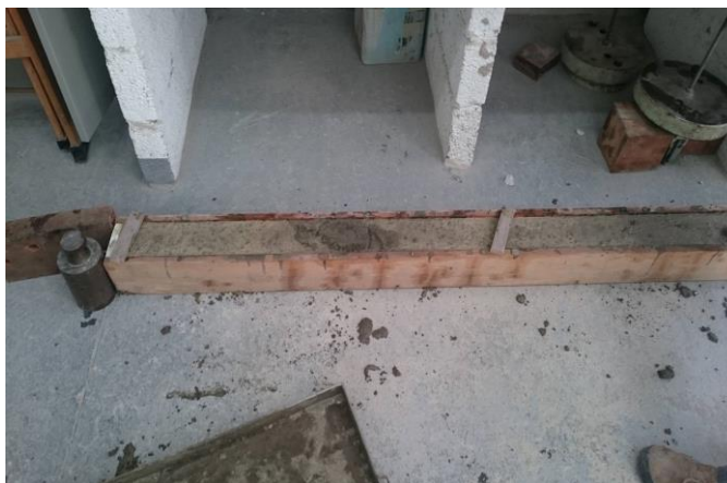
Figura 35 - Segunda viga antes de ser retirada da forma.
