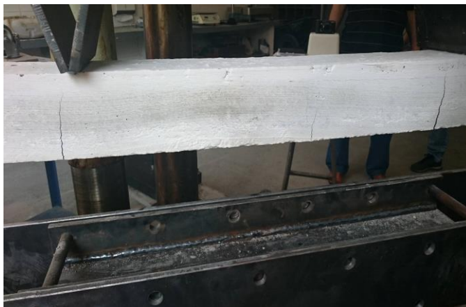
Figura 47 - Fissurações do lado oposto da viga à 0,26 tf.
