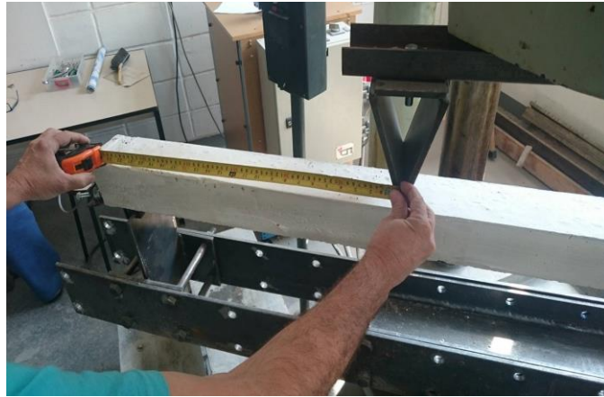
Figura 39 - Viga sendo instalada na máquina de ensaio universal.
