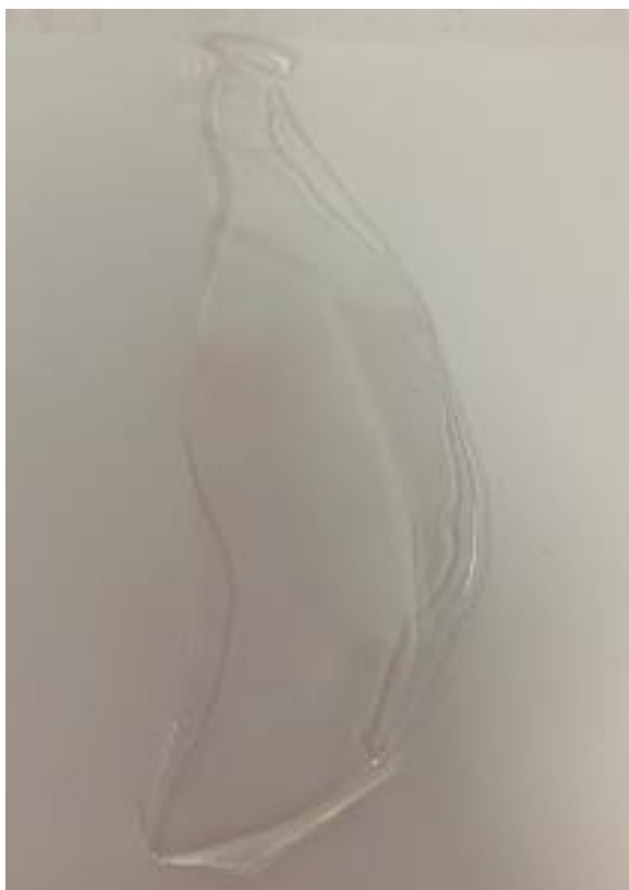
Figura 15: Amostra final com grãos de tamanhos semelhantes e temperatura inicial do processo ajustada
