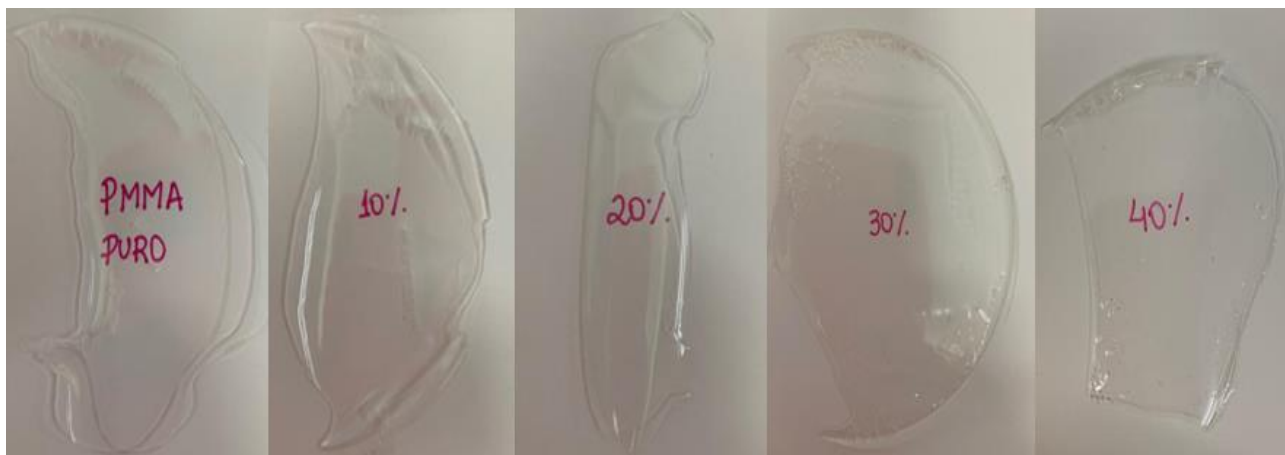
Figura 11: Amostras Obtidas neste estudo de PMMA Puro e PMMA dopado com \text{WO}_3
