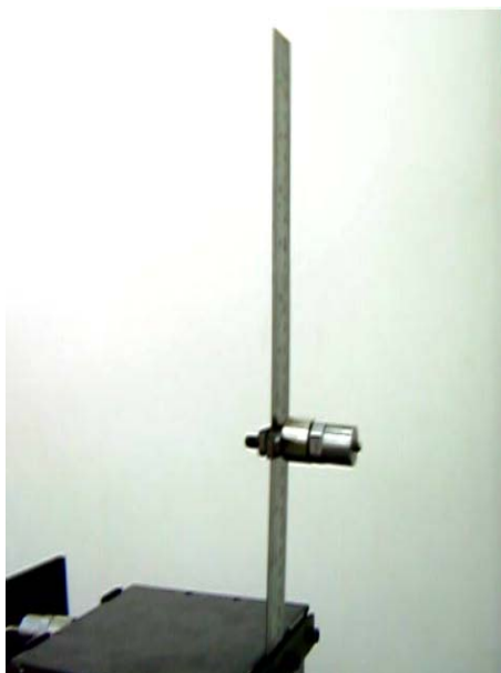
Figura 9 13. Configuração de estrutura secundária na minimização da amplitude de vibração da mesa superior.
