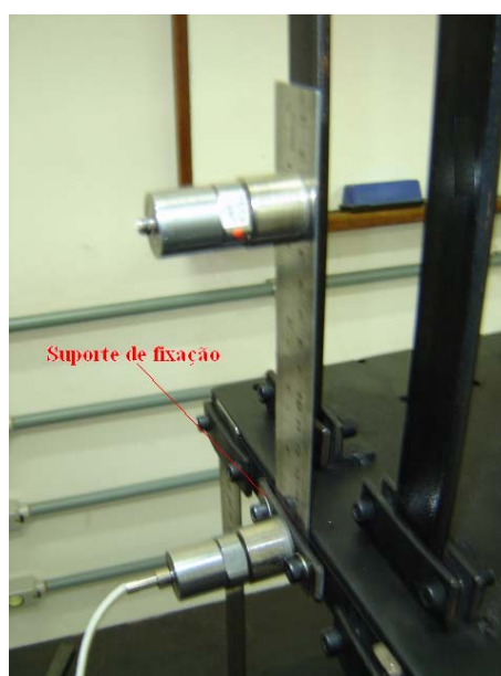
Figura 9.3. Configuração de estrutura secundária na minimização da amplitude de vibração da mesa inferior.
