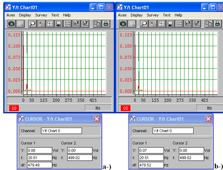
Figura 9 16. Amplitude (Volts) x Freqüência (Hz) para • excitação= 20,51 Hz. a-) Sem ADV. b-) Com ADV.
