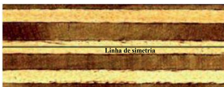
Figura 3 - Mostra a linha de simetria de um painel compensado de 7 lâminas.
