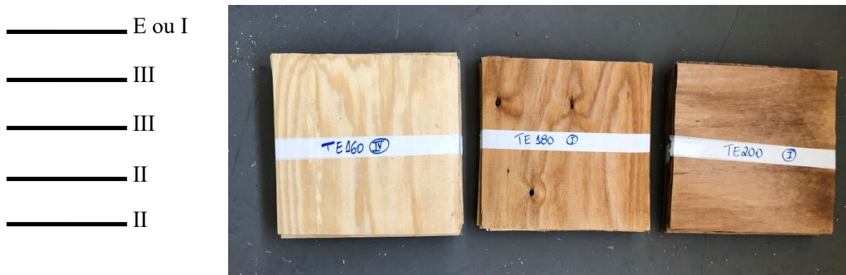
Figura 19 - Separação das lâminas conforme classificação visual e tratamento.
