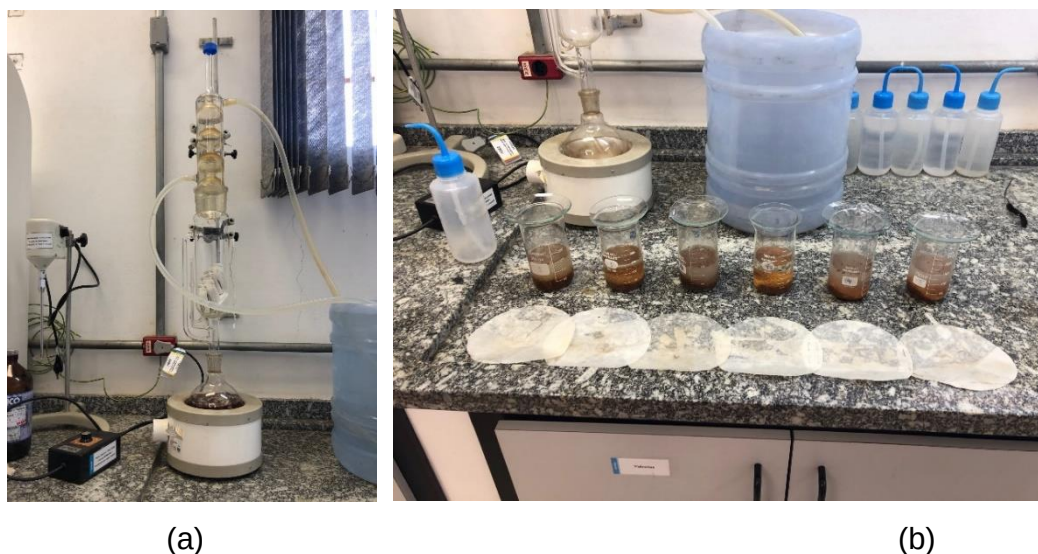
Figura 14 – Etapas do processo de extração: (a) extração com etanol-tolueno e etanol e (b) material sendo preparado para o banho-maria.
