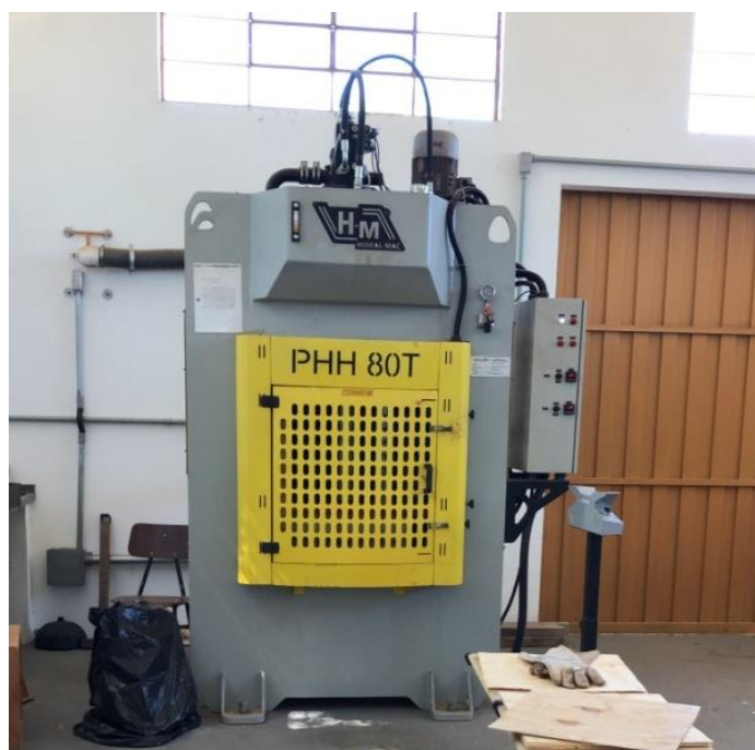
Figura 12 - Prensa utilizada no tratamento térmico das lâminas.
