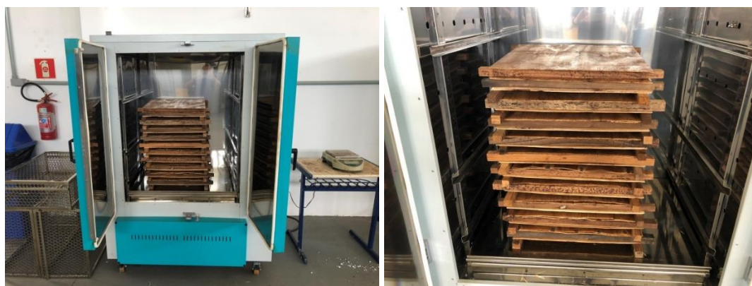
Figura 10 - Condicionamento das lâminas dentro da estufa para o tratamento térmico.
