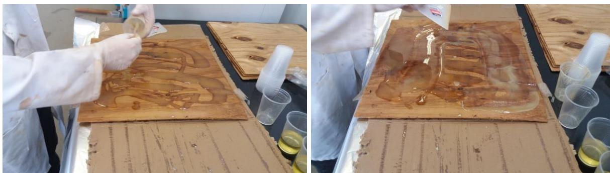
Figura 20 - Aplicação do adesivo.
