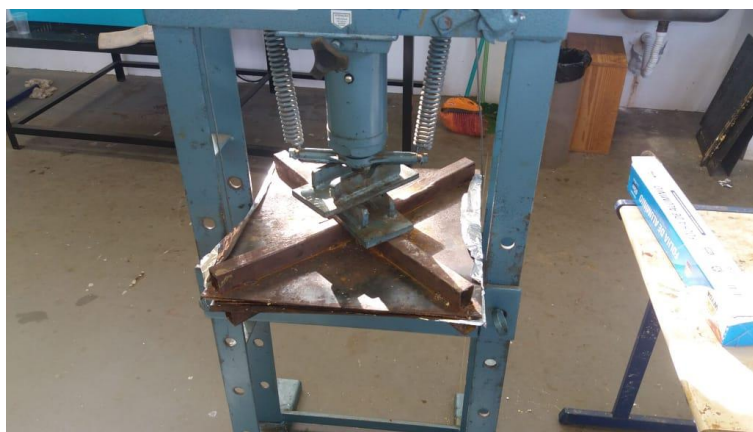
Figura 22 – Pré-prensagem do painel.
