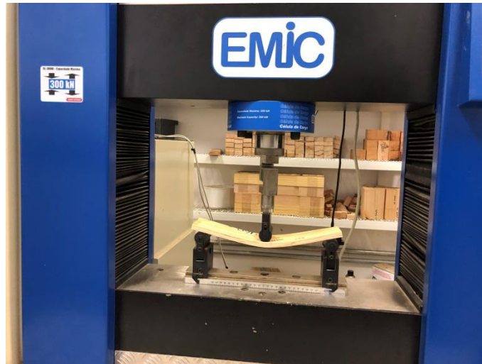
Figura 29 - Ensaio de flexão estática paralela e perpendicular.
