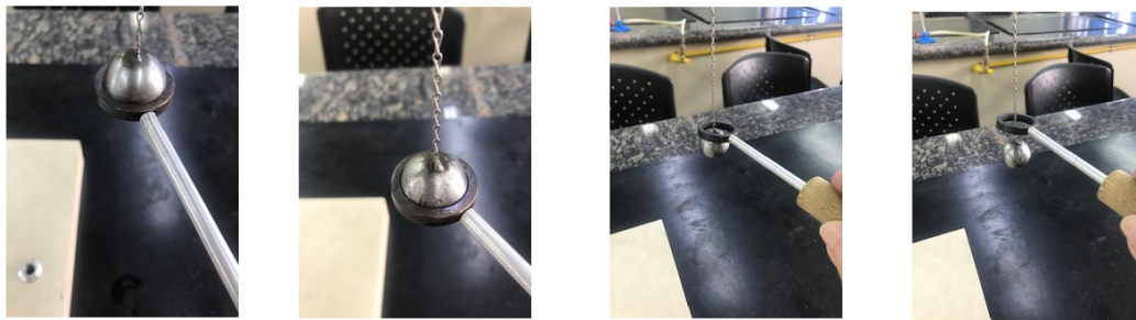
Figura 3.18: O aro sendo aquecido até que passa pela esfera
