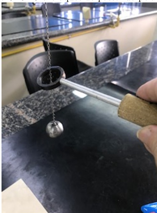
Figura 3.19: O aro aquecido passando pela esfera
