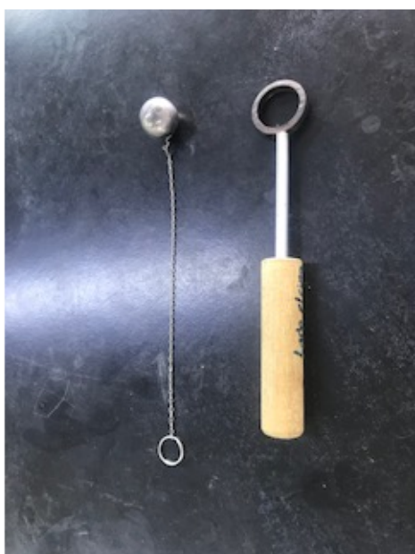
Figura 3.13: Um cabo de madeira com aro de alumínio, esfera e bico de Bunsen
