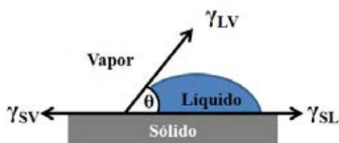
Figura 13. Representação das energias interfaciais e ângulo de contato, adaptado de [40].
