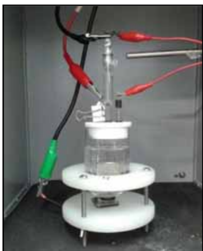
Figura 16. Célula eletroquímica na gaiola de Faraday utilizada para as medidas de EIS.
