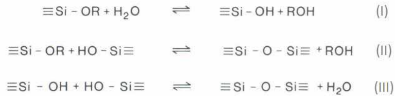
Figura 3. Reações de hidrólise e condensação do processo sol-gel, adaptado de [18].
