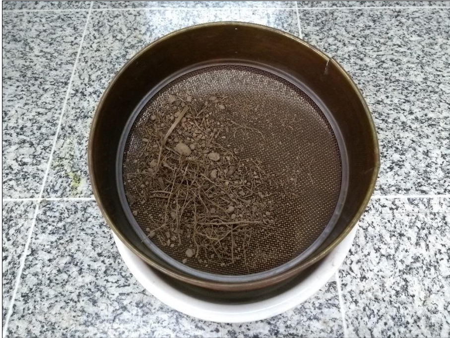
Figura 6. Amostra bruta sendo peneirada utilizando-se peneira de 1 mm de abertura
