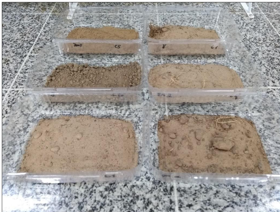
Figura 5. Amostras em processo de secagem antes do início da análise granulométrica
