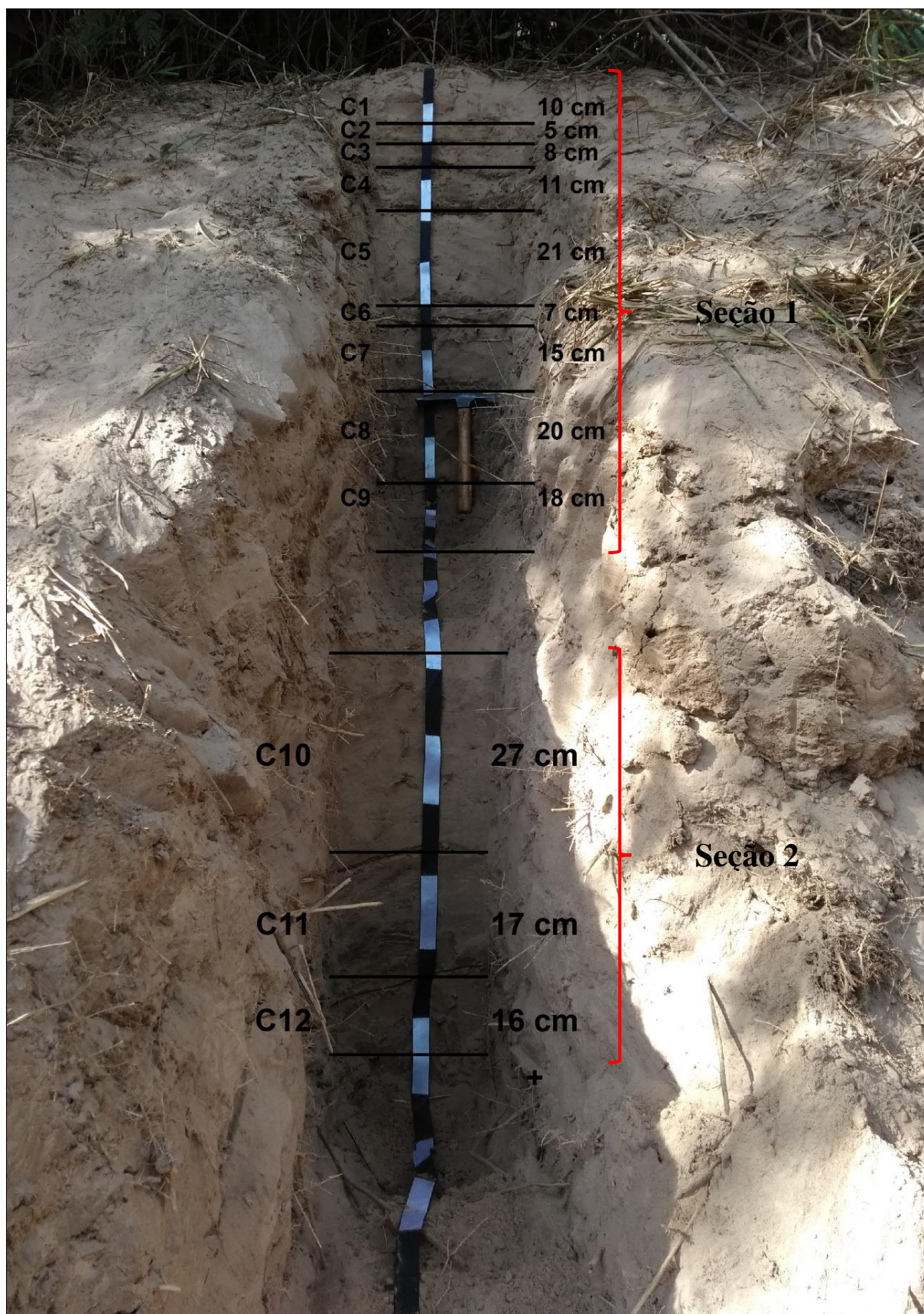
Figura 72. Perfil do depósito no ponto RM2 com camadas identificadas e suas respectivas espessuras
