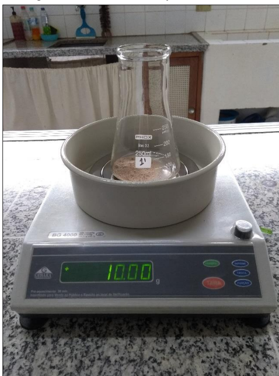
Figura 8. Pesagem de 10 g de amostra no erlenmeyer utilizando-se a balança semi-analítica
