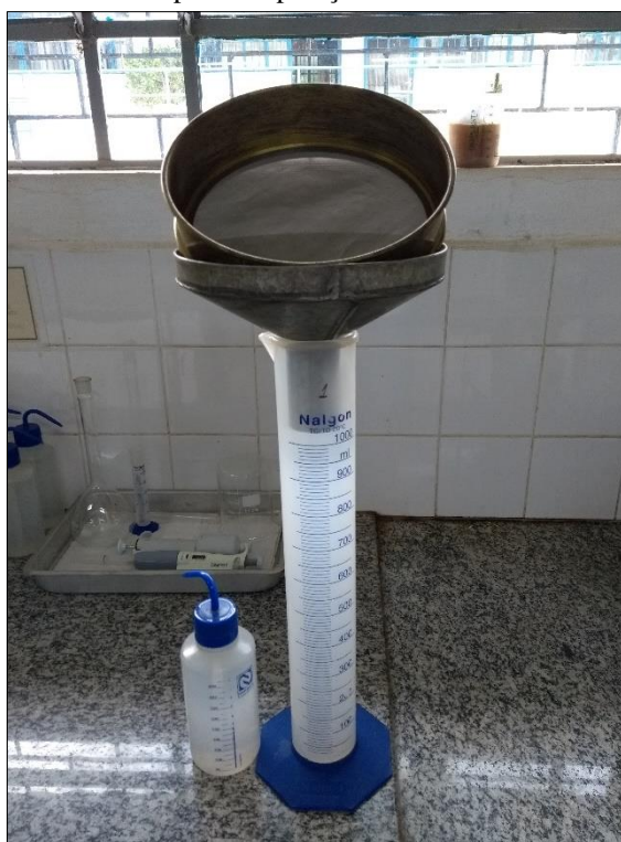
Figura 11. Conjunto de pisseta com água deionizada, peneira de 0,053 mm, funil e proveta de 1000 ml utilizado para a separação da areia
