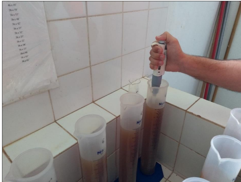
Figura 14. Pipetagem da argila na proveta e transferência do conteúdo para o béquer
