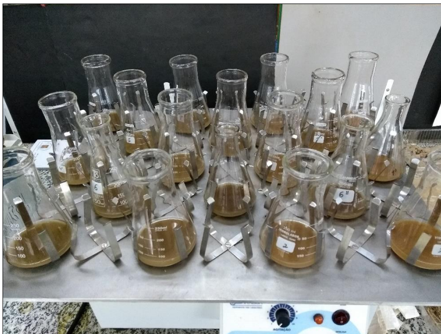
Figura 9. Erlenmeyers contendo amostras com NaOH e água deionizada na mesa agitadora
