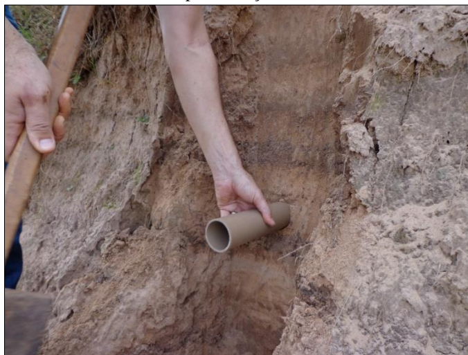
Figura 16. Coleta de amostra para datação utilizando tubo coletor de PVC
