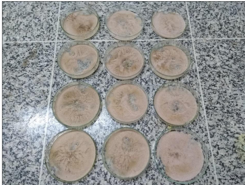
Figura 12. Placa de Petri contendo areia após secagem na estufa e pesagem utilizando balança semi-analítica
