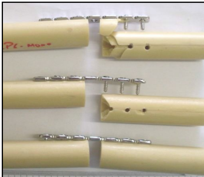
Figura 9 - Aparência das montagens das placas de reconstrução bloqueadas do Grupo 1, após o ensaio de flexão estática em quatro pontos.
