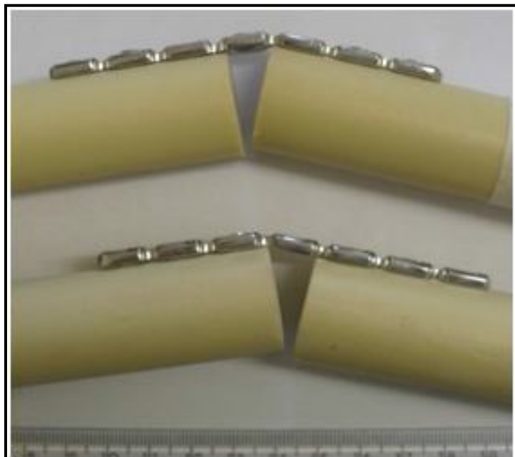
Figura 15 - Aparência das falhas das montagens das placas de reconstrução bloqueadas do Grupo 1, sob ensaio de compressão axial em fadiga.
