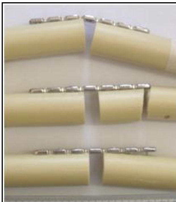
Figura 19 – Aparência das falhas das montagens das placas de reconstrução bloqueadas do Grupo 1, sob ensaio de flexão em quatro pontos em fadiga.
