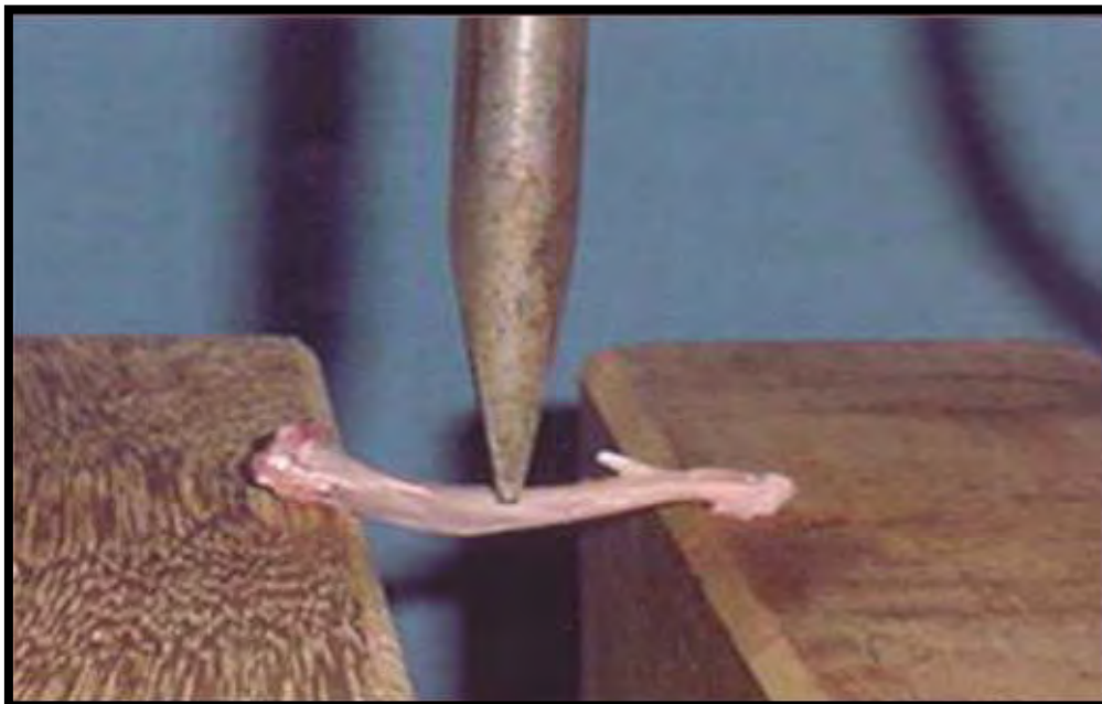
Figura 8 – Detalhe do corpo de prova montado em dois apoios e do cutelo de aplicação de carga locado em ponto equidistante às extremidades
