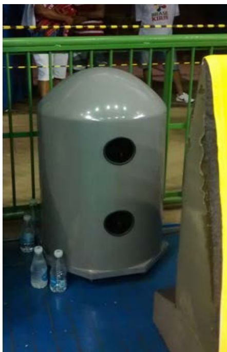
Figura 4: Câmera localizado nas linhas de fundo e laterais da quadra para detecção de bola “dentro ou fora”
