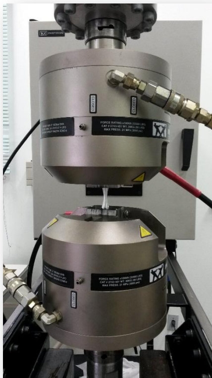
Figura 36: Servo-hidráulica para ensaio de fadiga
