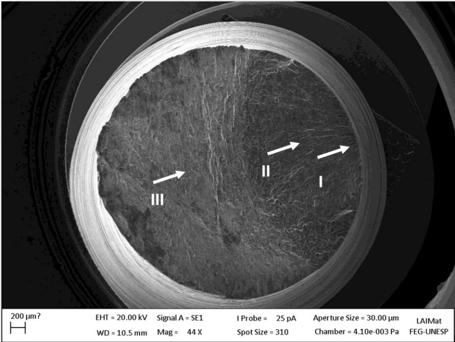
Figura 81: MEV AC – visão geral – 340 MPa, 23 873 ciclos
