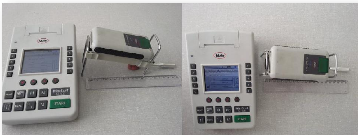
Figura 34: Rugosímetro da marca Mahr e modelo MarSurf M 300 + RD18
