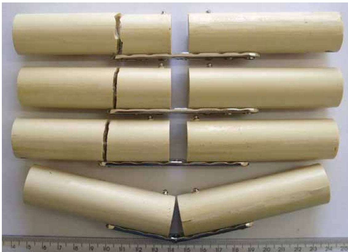
Figura 18 - Aspecto das montagens do Grupo 1, após o teste de flexão em quatro pontos em fadiga.
