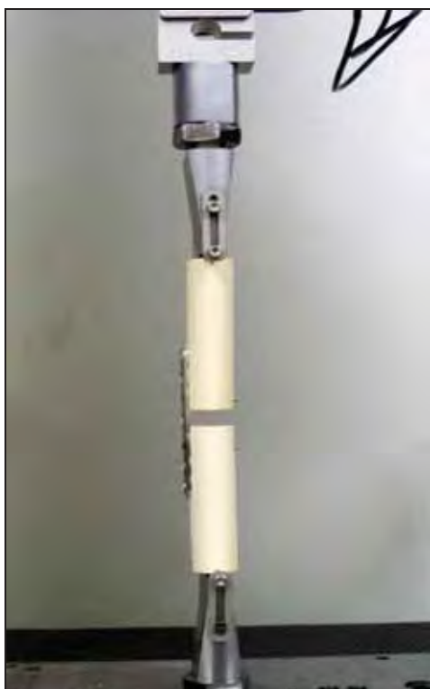
Figura 5 – Montagem do ensaio de compressão.
