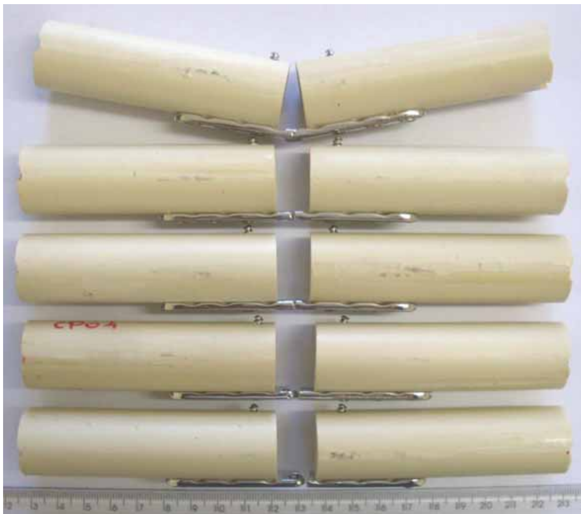
Figura 14 – Aspecto das montagens do Grupo 1 após o teste de compressão axial em fadiga.
