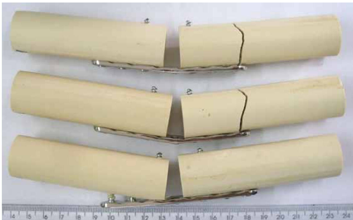
FIGURA 12. Aspecto das montagens do Grupo 1 após o teste de flexão estática em quatro pontos
