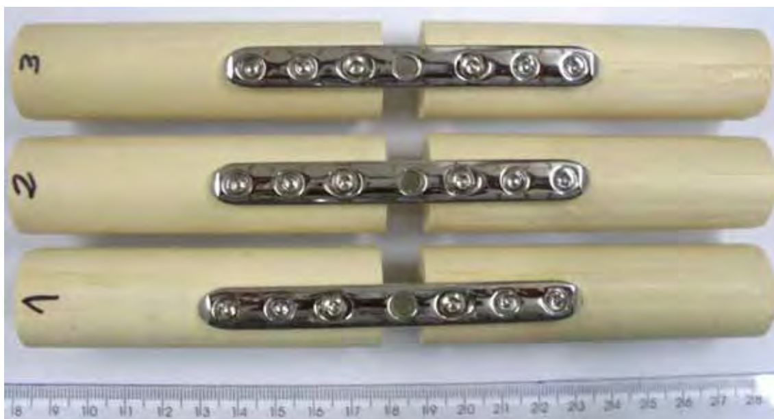
Figura 8 – Aspecto de todas as montagens antes dos testes.
