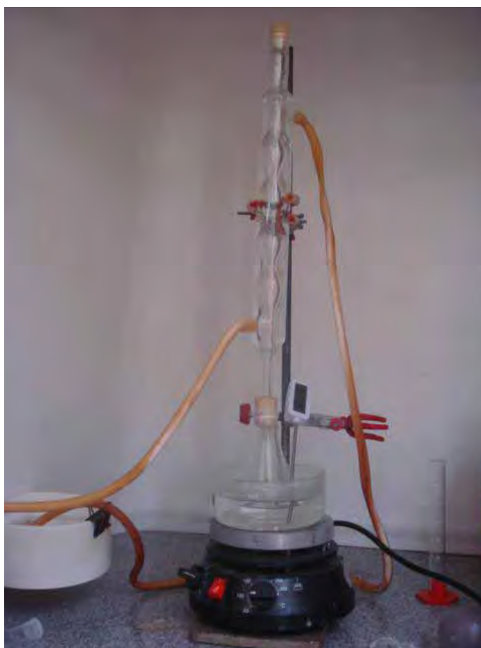
Figura 3.1: Sistema de refluxo de vapores usado para síntese dos géis.
