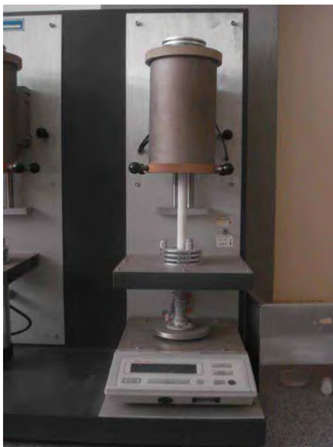
Figura 3.7: Foto do forno acoplado a balança, utilizado para análise termogravimétrica dos géis
