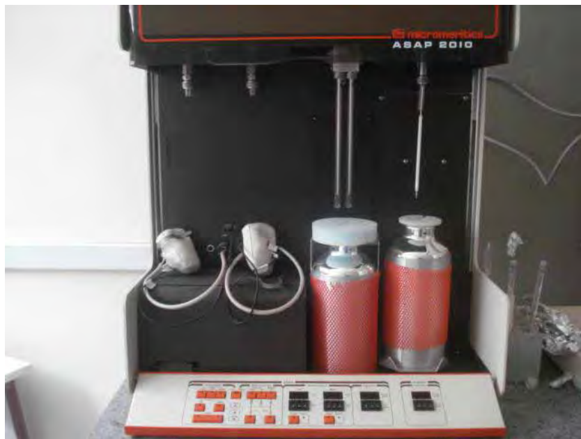
Figura 3.10: Aparelho usado para fazer análises de adsorção de nitrogênio.
