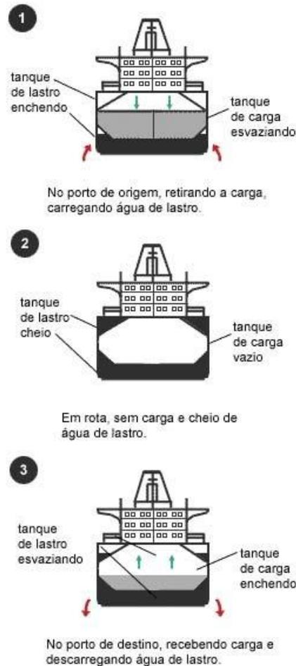
Figura 2. Representação do processo de lastrear um navio.
