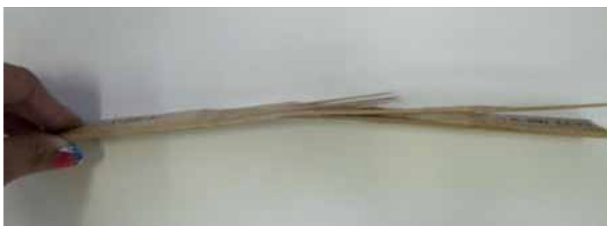
Figura 24- Corpo de prova após ter sofrido tração paralela às fibras.
