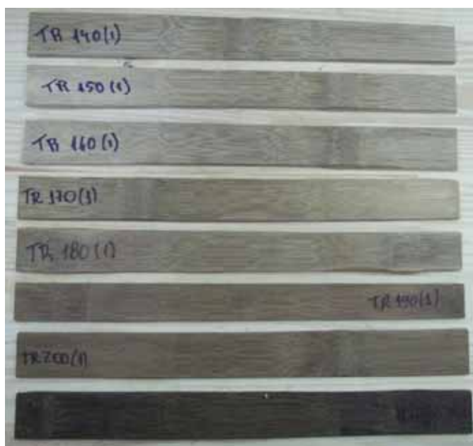
Figura 20- Corpos de prova utilizados em cada temperatura no tratamento térmico.
