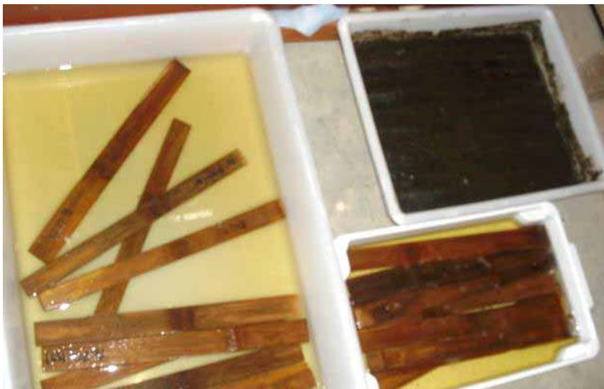
Figura 17- Corpos de prova tratados com ácido pirolenhoso de eucalipto (à esquerda), ácido pirolenhoso de Bambusa vulgaris (à direita- parte inferior) e Neem (à direita- parte superior).
