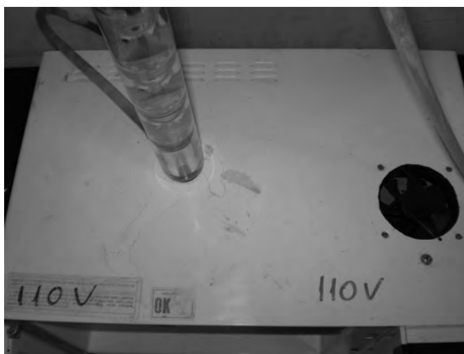
Figura 19. Adaptação do forno de micro-ondas doméstico para realização de refluxo (furações da cuba, revestimento com anel de cobre e cooler).
