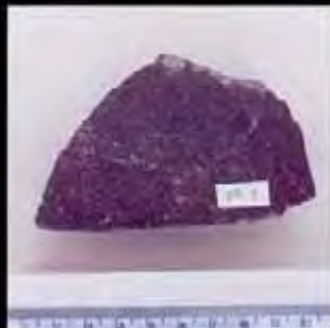
Foto 08 - Amostra (P2) de basalto afanítico, maciço, cinza escuro com tons violáceos, do afloramento da cava 1 (CV1) da antiga Pedreira da RFFSA, localizada no Parque Ecológico Baguaçu.
