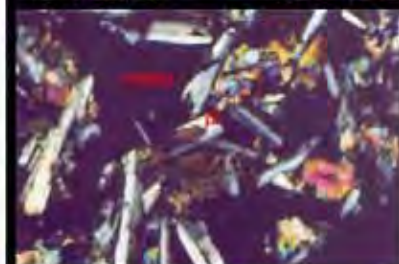
Foto 74 - Fotomicrografia (x2,5), a nicóis cruzados, de fragmentos de basalto (amostra PMA74) do poço profundo do PMA, representativo do intervalo de profundidade de 72 a 74 metros, onde se observa matriz constituída predominantemente por material vítreo, clinopiroxênios (cpx) intersticiais e plagioclásios (pl) tipo "canda de andorinha", típica de resfriamento rápido.
