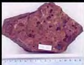
Foto 09 - Amostra (P4) de basalto vesicular, cinza amarronado, com tons avermelhados/arroxeados, do afloramento da cachoeirinha do Ribeirão Baguaçu, localizada no Parque Ecológico Baguaçu.
