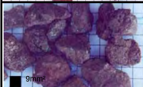
Foto 46 - Amostra de calha (PMA558) representativa do intervalo de profundidade de 556 a 558 metros. Fragmentos de basalto vesicular/amigdaloidal, cinza avermelhado/arroxado.
