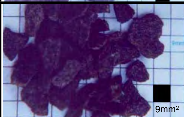
Foto 55 - Amostra de calha (PMA846) representativa do intervalo de profundidade de 844 a 846 metros. Fragmentos de basalto maciço , cinza escuro.
