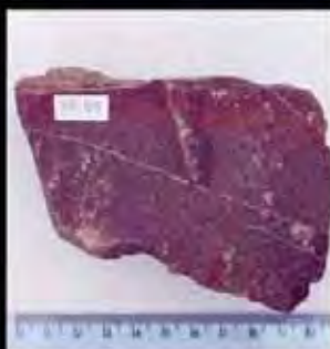
Foto 10- Amostra (P5) de basalto afanítico, maciço, cinza a marrom avermelhado com tons arroxeados, do afloramento da cava 2 (CV2) da antiga pedreira da RFFSA, localizada na avenida dos Araças, nas proximidades do Parque Ecológico Baguaçu.
