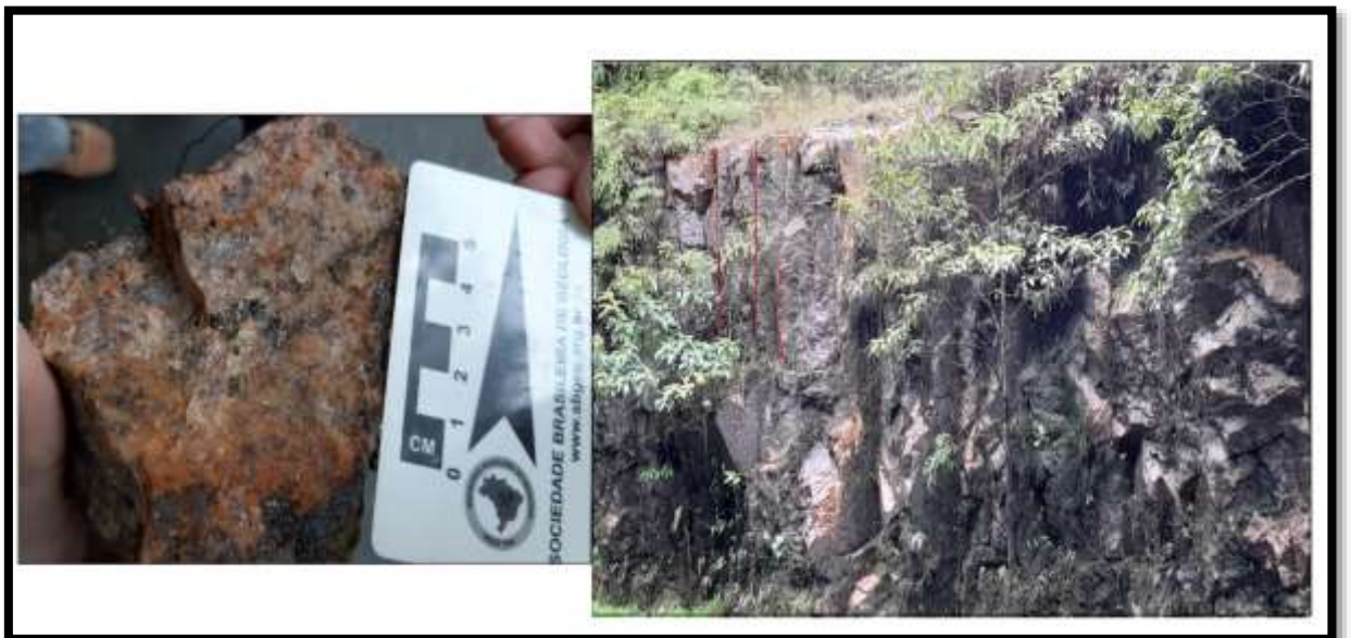
Figura 21: Plano de foliação bem marcado em granito (Rodovia dos Tamoios (SP-99))
