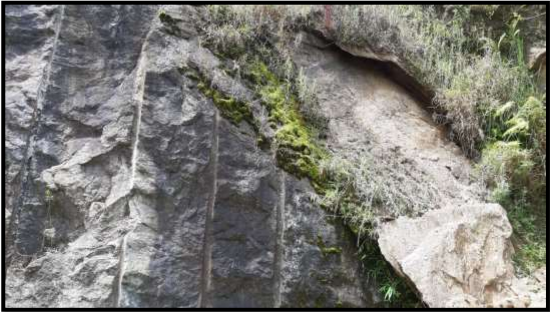
Figura 27: Deslocamento ocorrido no plano de foliação do gnaisse
