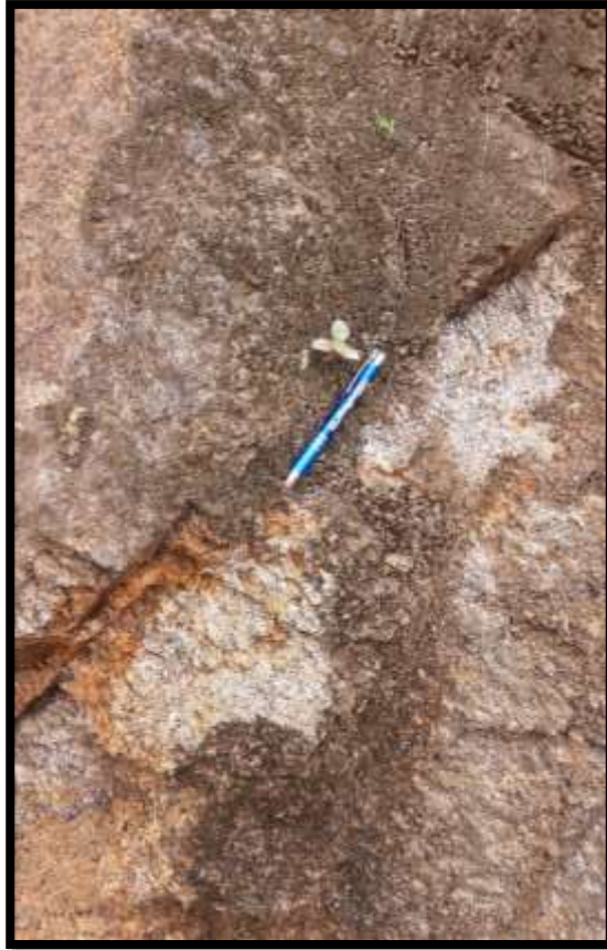
Figura 22: Plano de fratura encontrado em granito
