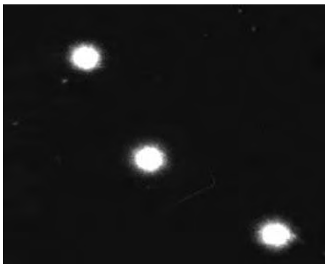
Figura 7: Imagens de cometa obtidas durante a realização do teste de genotoxicidade. Microscopia de fluorescência 400X.
