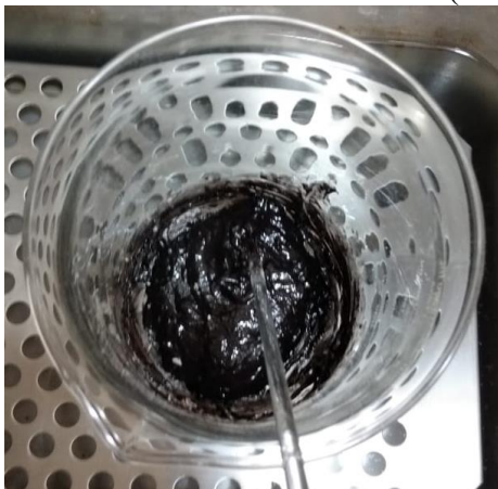
Figura 20 – Hidrólise ácida concentrada (Polpa soda).
