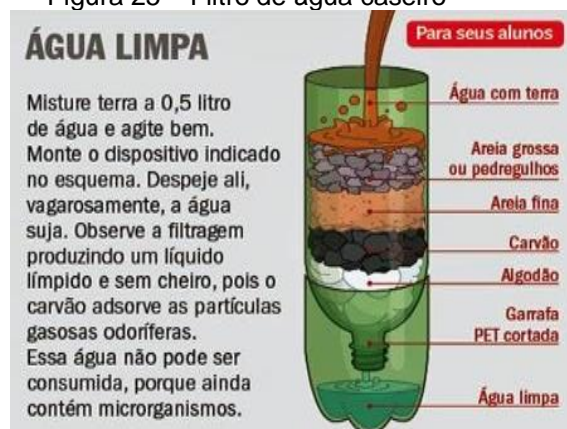
Figura 25 – Filtro de água caseiro
