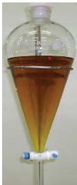
Figura 3.11: Final do processo de decantação das matérias-primas transesterificadas por rota etílica: fases misturadas.
