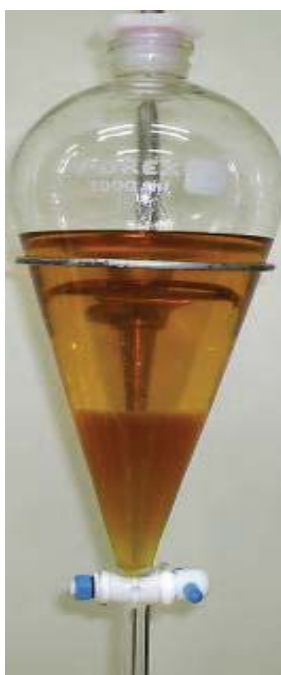
Figura 3.4: Processo de decantação do óleo de soja degomado transesterificado utilizando metóxido de sódio.
