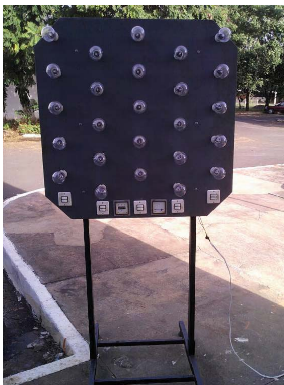
Figura 3.19: Painel de cargas utilizado nos testes do moto-gerador.
