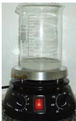
Figura 3.2: Processo de formação do metóxido de sódio.
