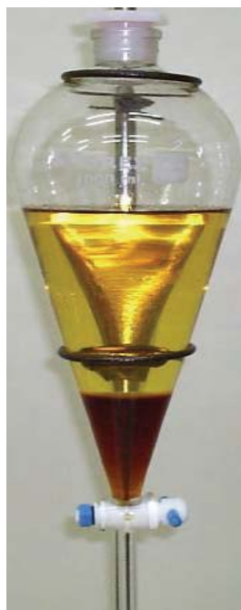
Figura 3.8: Processo de decantação do óleo de fritura pré-tratado e transesterificado utilizando metóxido de sódio.
