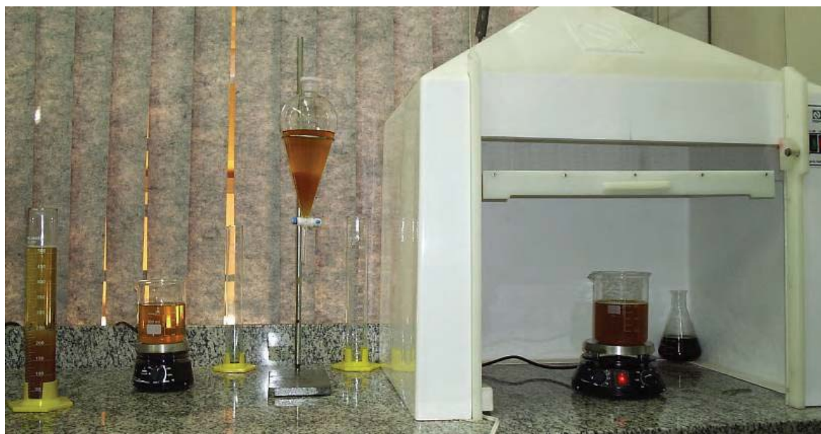
Figura 3.1: Bancada de laboratório para realização dos processos de obtenção do biodiesel.
