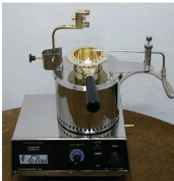
Figura 3.17: Equipamento utilizado para determinação do ponto de fulgor.
