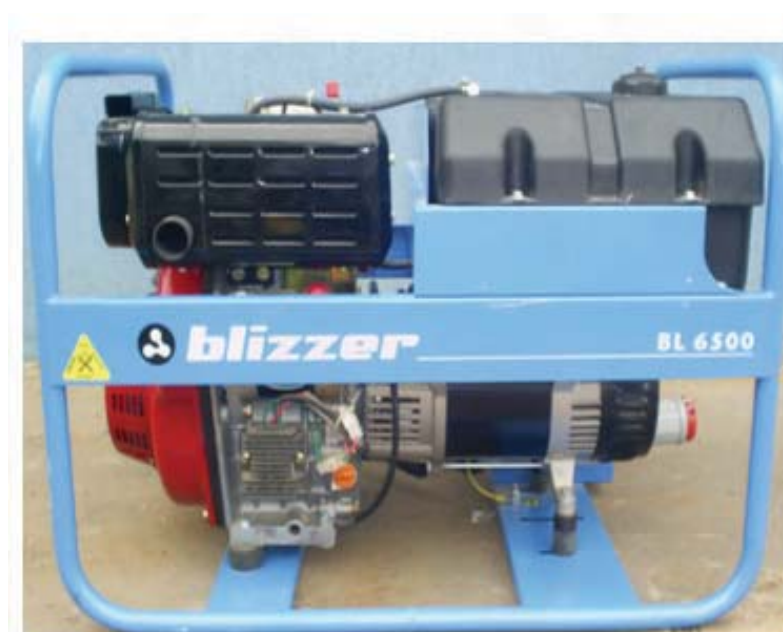
Figura 3.18: Grupo gerador utilizado nos testes com biodiesel.
