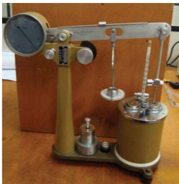
Figura 3.16: Equipamento utilizado para determinação da viscosidade.
