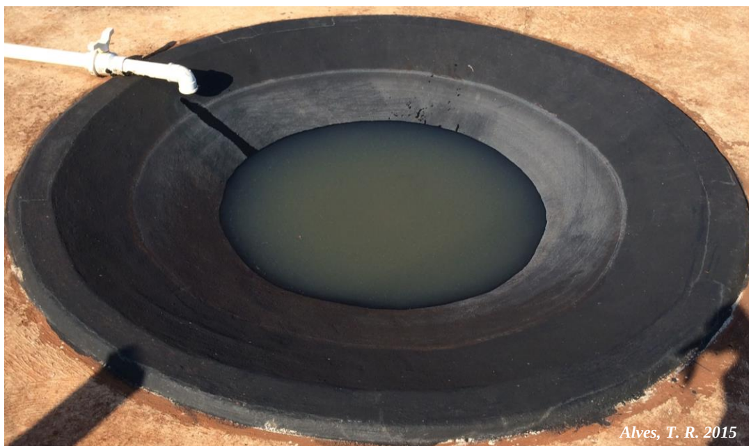
Figura 3 - Reator solar com lâmina de 10 cm de profundidade.
