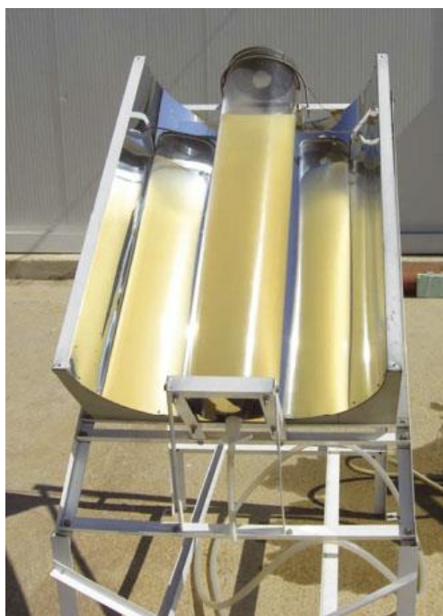
Figura 1 - Reator solar com coletor parabólico composto, desenvolvido por Ubomba-Jaswa et al. (2010).
