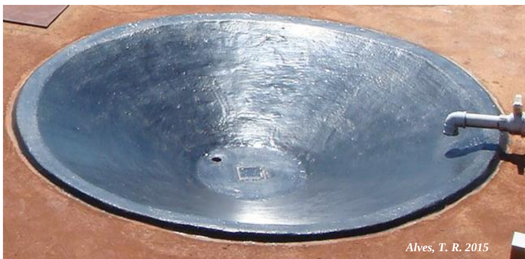
Figura 2 - Reator solar com formato de tronco cônico invertido.
