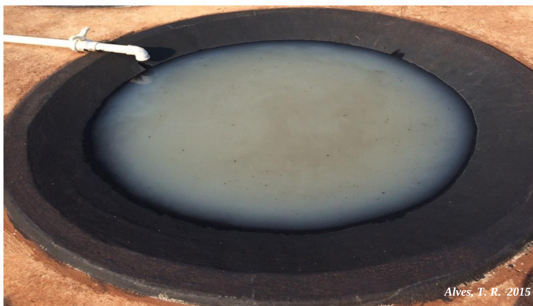
Figura 4 - Reator solar com lâmina de 20 cm de profundidade.
