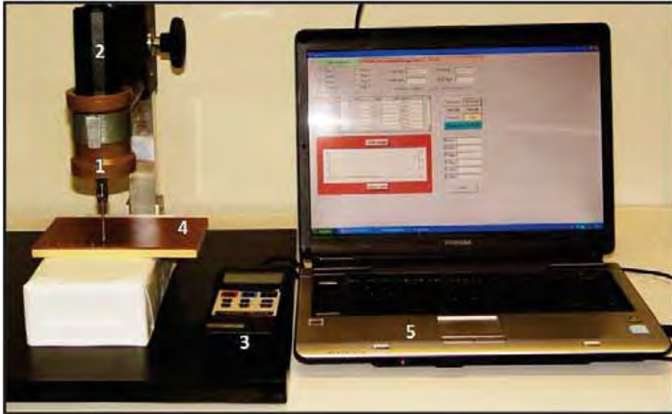
Fig 5. Base direcionadora do torquímetro (1), torquímetro digital (2), painel indicador do sensor de torque (3), bloco de osso artificial (4), computador equipado com software apropriado para a medição (5).
