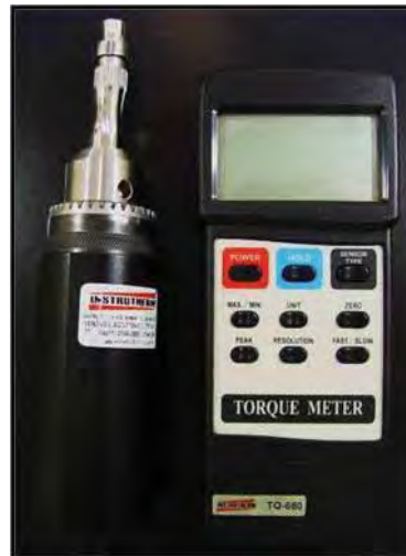
Fig 4. Torquímetro digital TQ 680 ( Instrutherm ) com chave de mão acoplada ao mandril.
