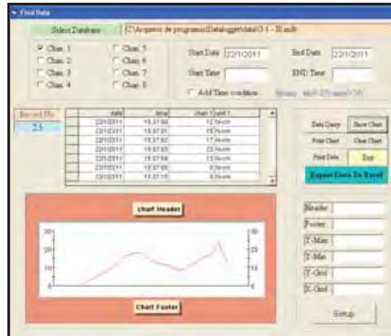
Fig 11. Curva representativa do torque de inserção: torque (Ncm) - ordenada e tempo (seg) - abscissa.
