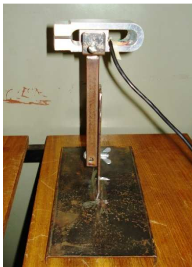
Figura 1: Pinça fixada ao pedestal de ferro adaptado, utilizada nas tarefas de preensão.
