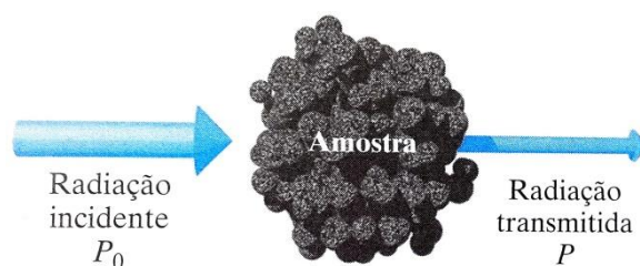
Figura 12 - Método de absorção. A radiação de potência incidente P_0 pode ser absorvida pelo analito, resultando em um feixe transmitido de menor potência radiante P .
