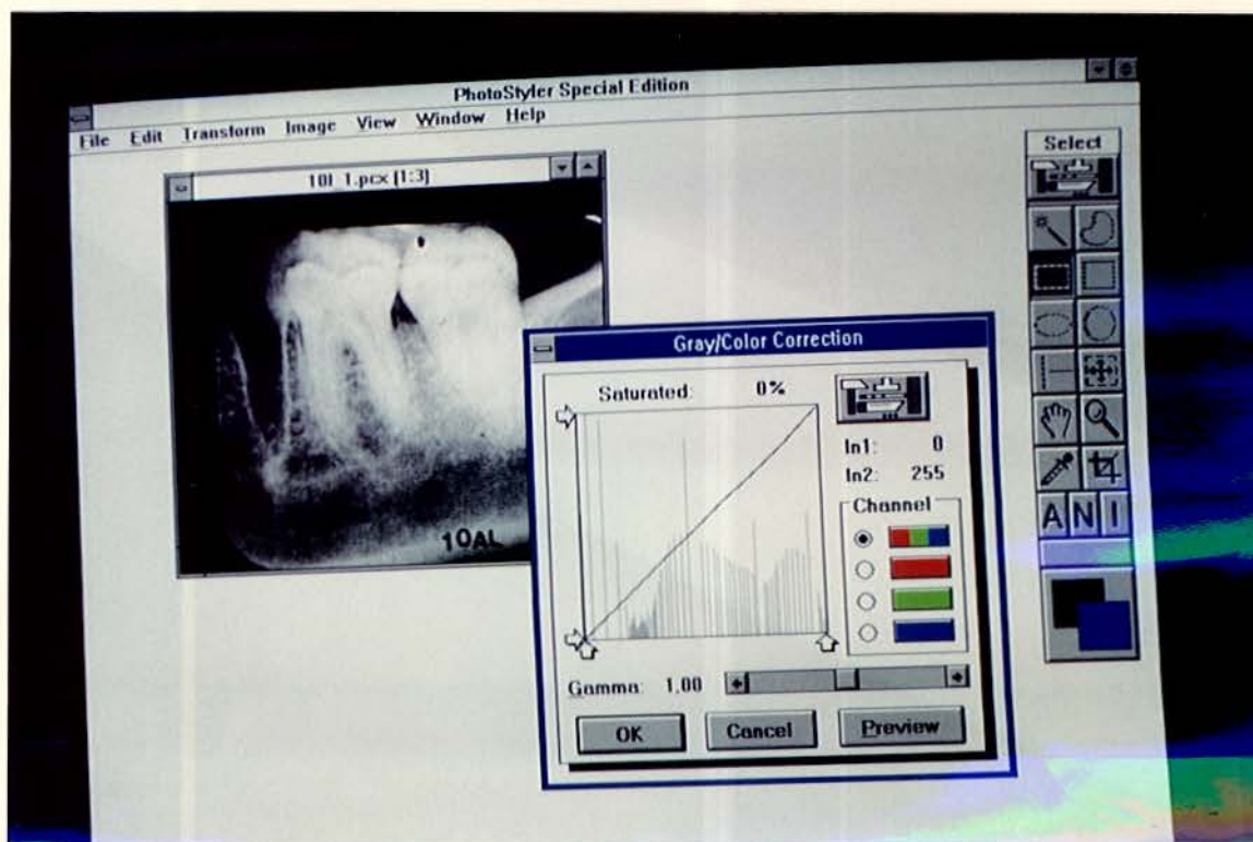
FIGURA 11 - Fotografia de uma imagem tratada (correspondente à imagem da figura 10 sem tratamento) mostrando melhora de contraste. Nota-se no histograma que os níveis de cinza se mostram bem distribuídos no intervalo de 0-255
