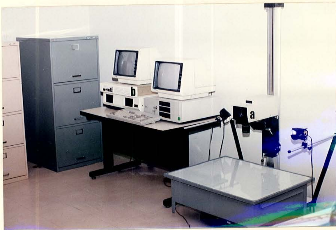
FIGURA 3 - Fotografia do equipamento empregado no trabalho onde pode ser observado em a a câmara para digitalização e em b a controladora da câmara, interligadas ao computador
