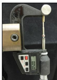
Micrômetro eletrônico digital com saída acoplado a uma base de microscópio e blocos fixados
