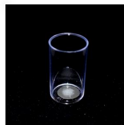
Desgaste ~50µm Lixa 400 (CARBIMET - BUEHLER)
