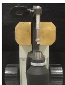
Micrômetro eletrônico digital com saída acoplado a uma base de microscópio e blocos fixados
