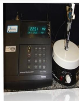
Eletrodo específico para F - ; Orion 9409-BN Microeletrodo de referência Analisador de íons
