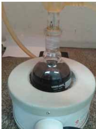
Figura 36 – Coloração escura do xileno durante o ensaio de teor de gel.
