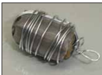
Figura 11 – Porta amostras feito para o ensaio de teor de gel.
