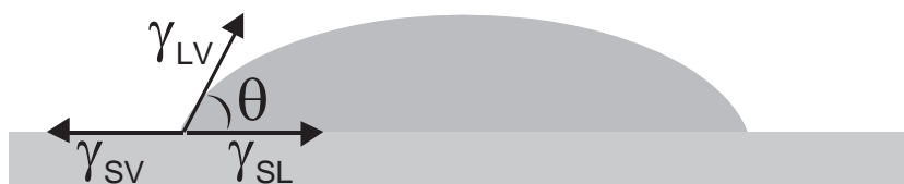
Figura 21 – Definição de ângulo de contato (RANGEL et al. , 2004; DARBELLO, 2008).
