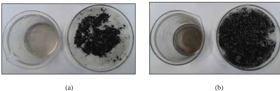
Figura 37 – Amostras de EVA ozonizado por 270 minutos, moído e imerso em (a) 1,2,4 Triclorobenzeno, (b) e Xileno e depois filtrado. O béquer do lado esquerdo das amostras ilustra o aspecto do solvente após filtragem.
