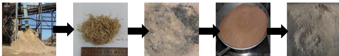
Figura 4. 9 – Processo de produção da cinza de bagaço de cana-de-açúcar
