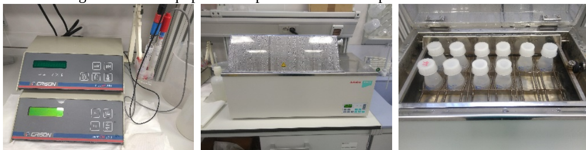
Figura 4. 17 – Equipamentos para as medidas de pH e de condutividade
