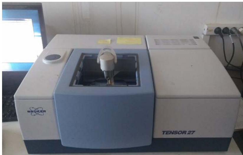
Figura 4. 12 - Espectrofotômetro de Infravermelho por Transformada de Fourier.
