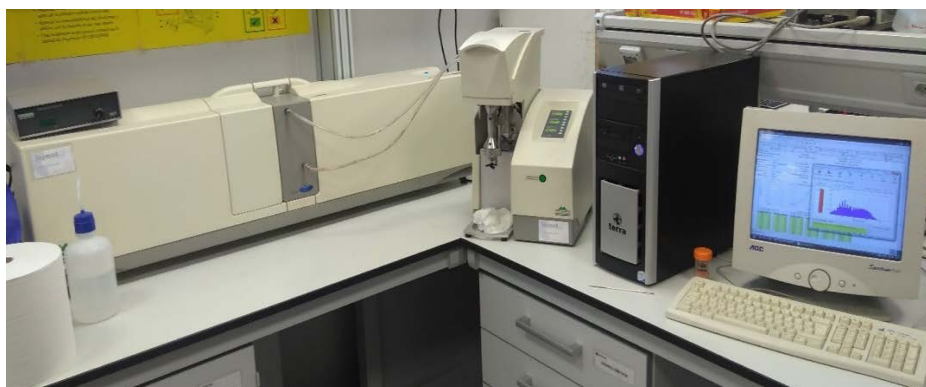
Figura 4. 14 - Equipamento para o ensaio de granulometria a laser
