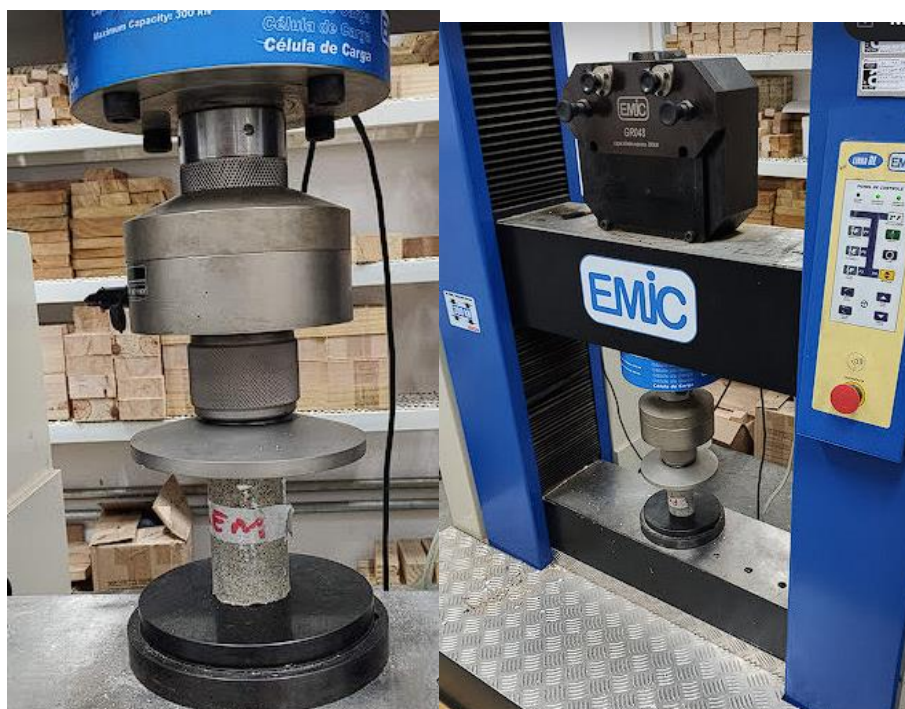
Figura 23 – Ensaio de compressão normal para determinação de rigidez e resistência.
