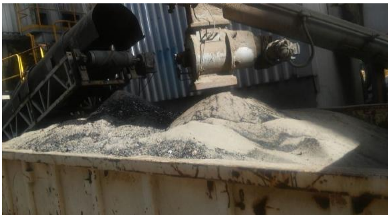
Figura 15 – Caçamba de cinzas após a queima da biomassa
