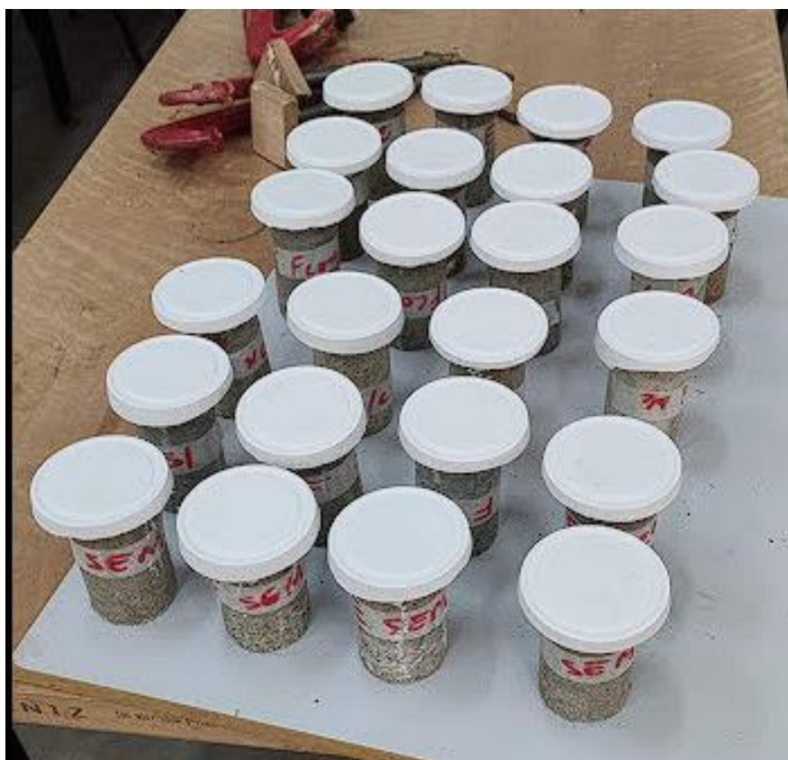
Figura 22 - Corpos de prova capeados para ensaio de compressão.
