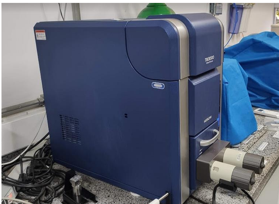
Figura 21 – Equipamento para o teste de microscopia eletrônica de varredura.
