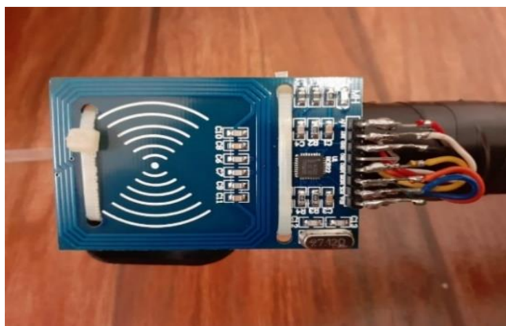
Imagem 36 – Leitor RFID instalado na lateral direita da base da bengala eletrônica
