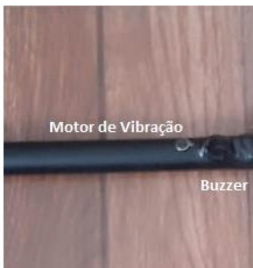
Imagem 33 – Motor de vibração e buzzer instalados na bengala eletrônica
