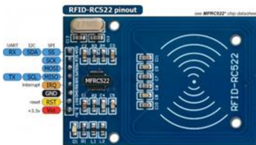
Imagem 37 – Pinagem do leitor RFID RC522
