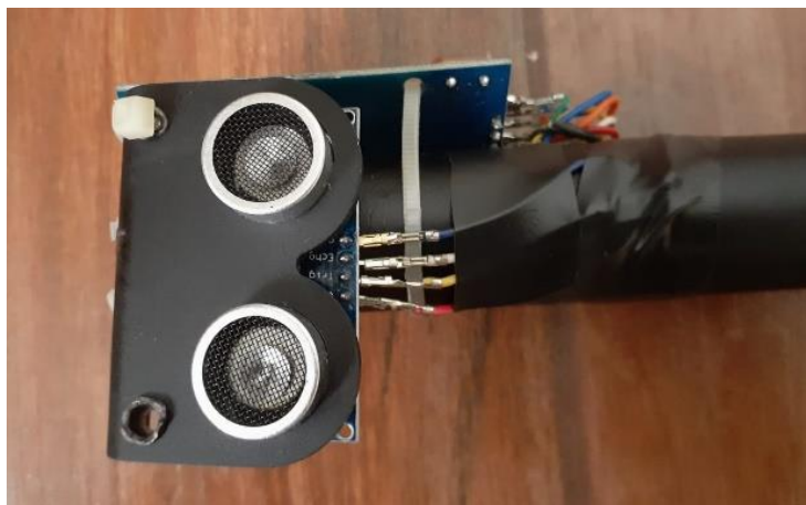
Imagem 32 – Sensor ultrassônico acoplado na base da bengala eletrônica
