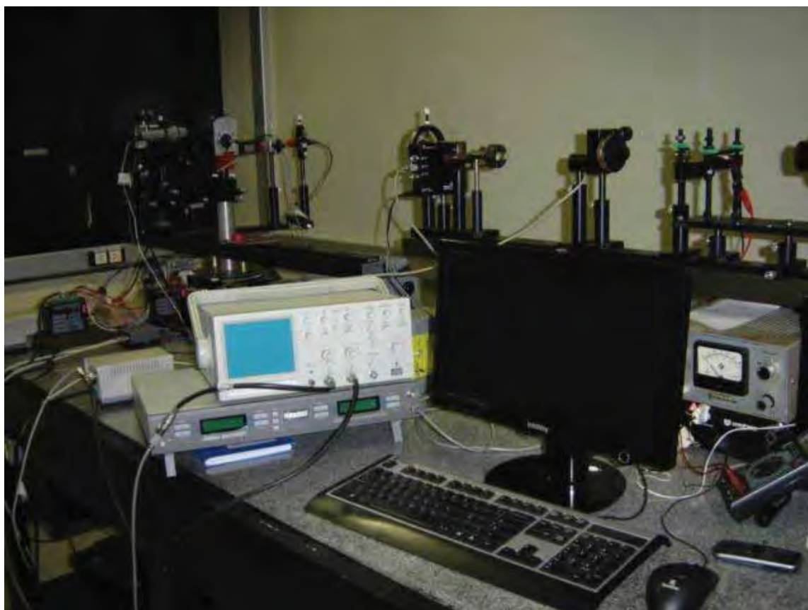
Figura 12 – Foto do equipamento óptico utilizado para investigar o efeito fotorrefrativo e o tempo de vida.
