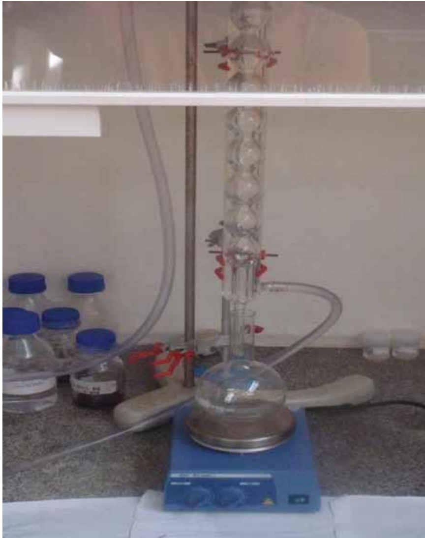
Figura 13 – Foto de montagem do sistema de Refluxo.
