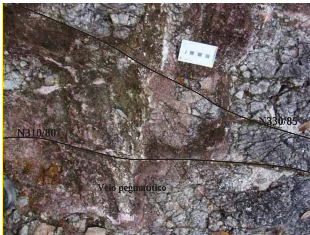
Figura 15 – Ponto 151 do trabalho de campo. Vista em planta. Quartzito de granulação grossa e coloração rósea apresentando veio pegmatítico sendo cortado por falhas.
