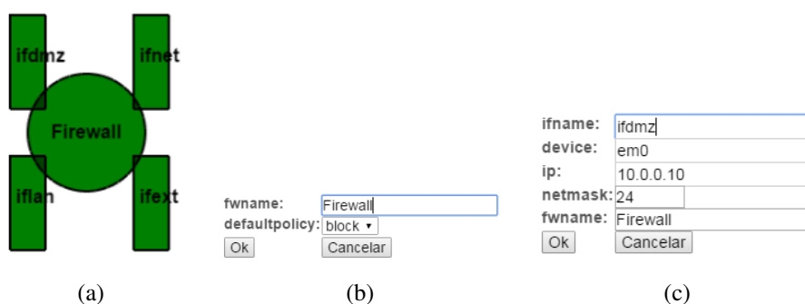
Figura 5.2: Componentes do firewall para a SPML2, (a) firewall com quatro interfaces, (b) atributos do firewall e (c) atributos da interface.
