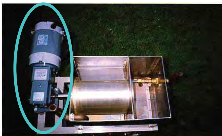
Figura 6 - Vista interna do equipamento construído pelo CEMEQ/UNESP – Botucatu, onde se pode observar a peneira rotativa e, no detalhe em azul, o moto-redutor.
