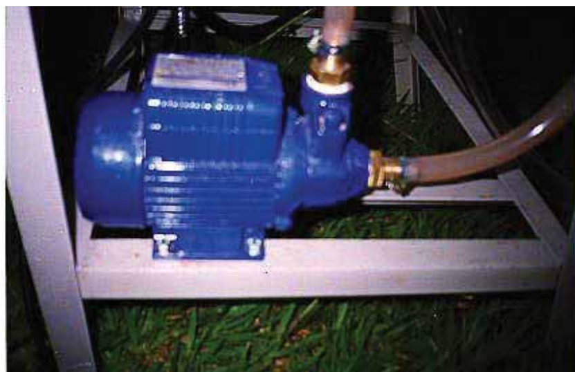
Figura 10 - Detalhe da bomba centrífuga KSB, utilizada no recalque do efluente dos reservatórios para o interior do sistema.
