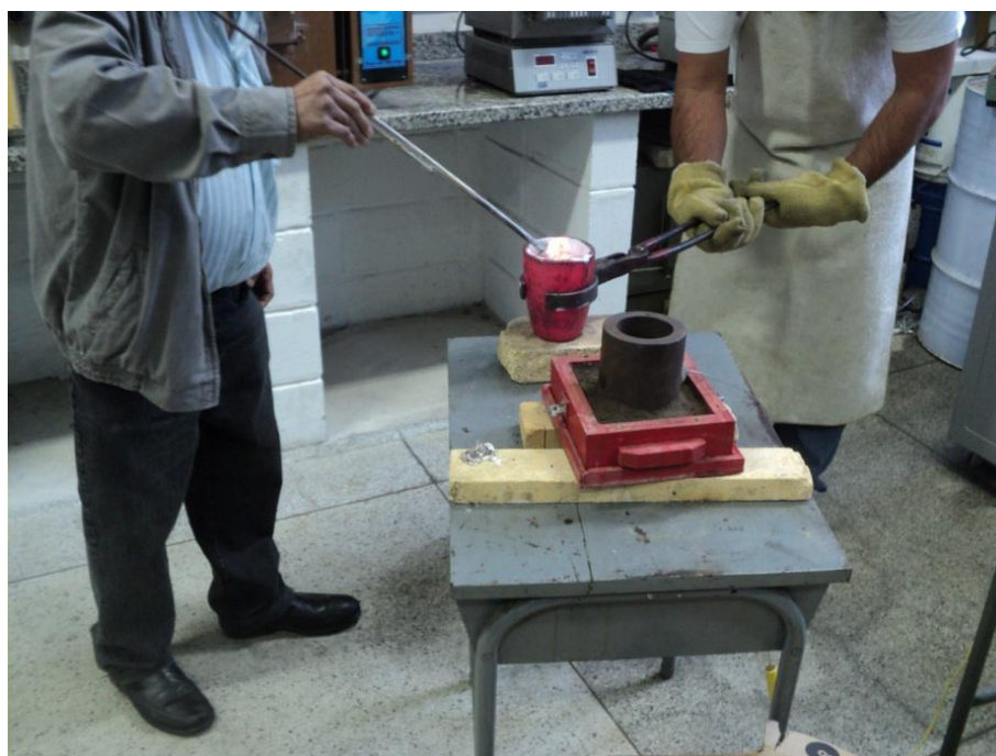
Figura 10 - Auxílio da escumadeira para retirada da escória. Fonte: Autor.
