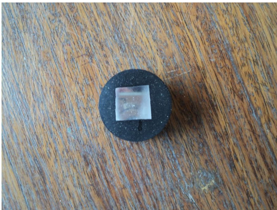
Figura 12 - Amostra do alumínio inserido no baquelite. Fonte: Autor.
