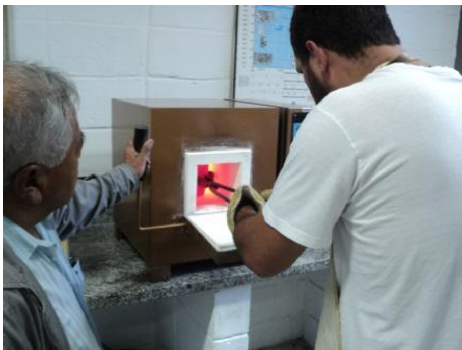
Figura 8 - Retirada do cadinho do forno com o auxílio da tenaz. Fonte: do autor.
