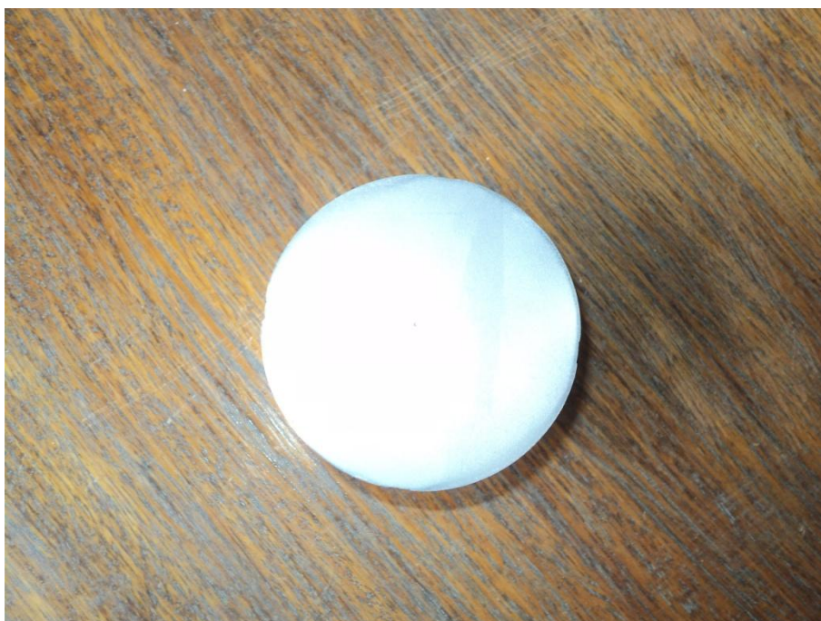
Figura 11 - Amostra lixada, antes do ataque químico. Fonte: Autor.
