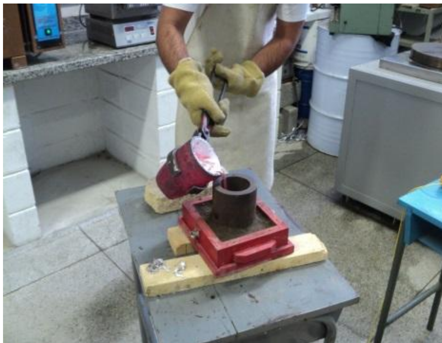
Figura 9 - Vazamento do fundido para o molde. Fonte: Autor.
