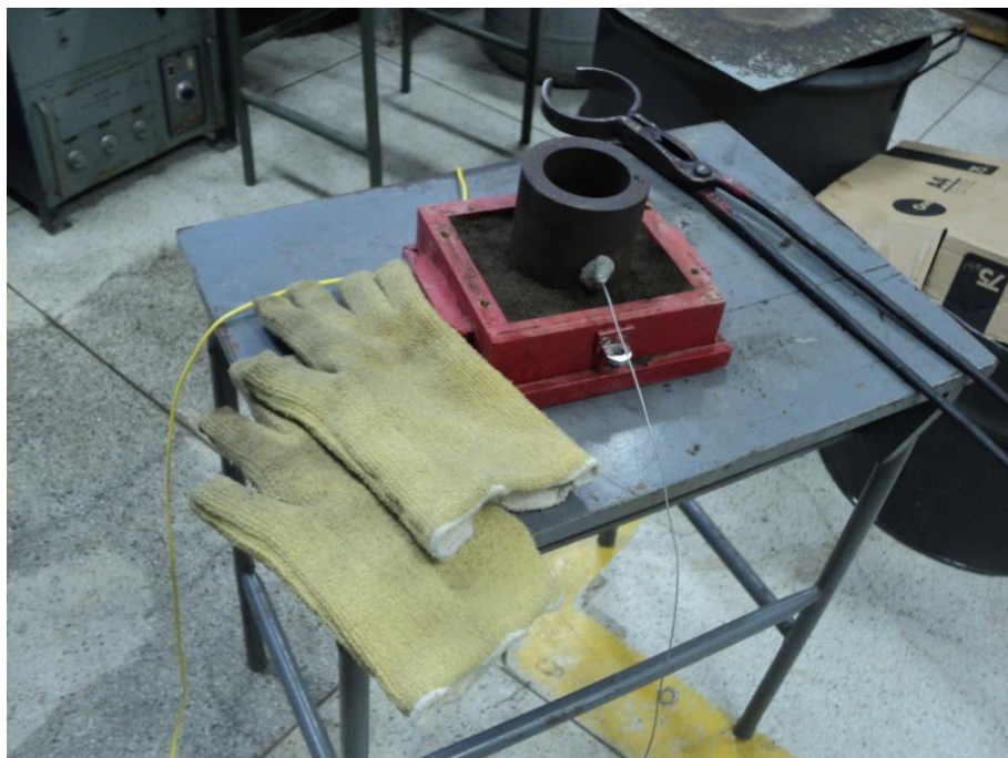
Figura 6 - Ilustração da construção do molde de fundição. Fonte: Autor
