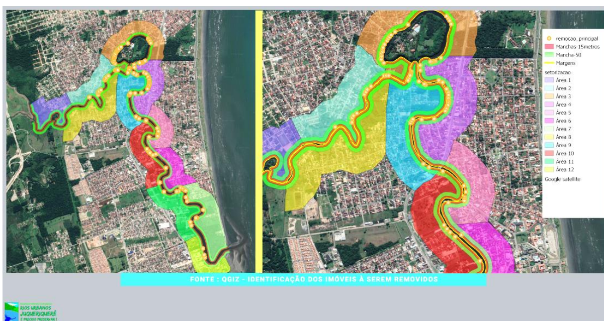
Figura 46 - Identificação das edificações dentro da FMP de 15 metros que precisariam ser realocadas (elaborado pelos alunos)
