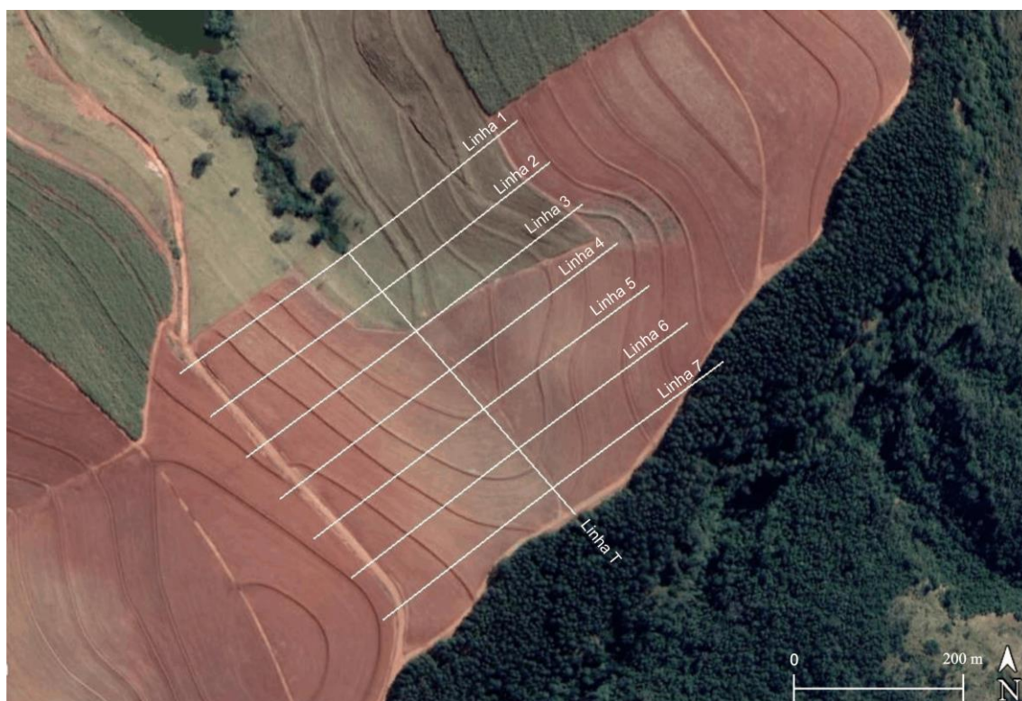
Figura 19: Disposição das 8 linhas de tomografia elétrica.
