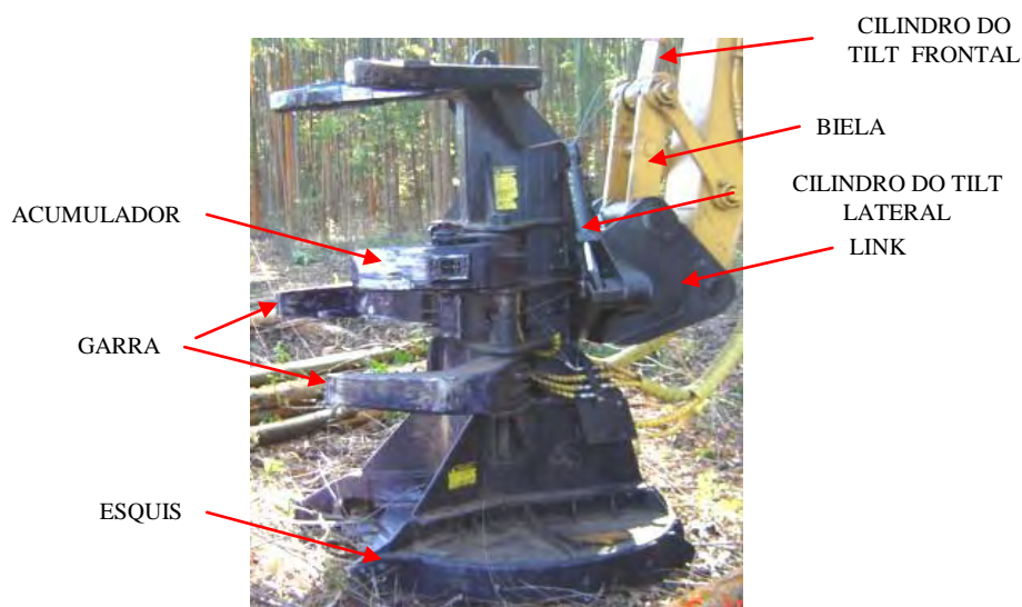
Figura 12. Cabeçote Feller-Buncher da marca Risley.
