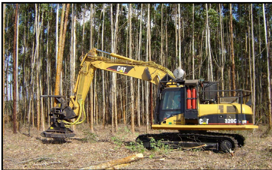
Figura 3. Máquina base Caterpillar 320 CL equipada com cabeçote Feller-Buncher.
